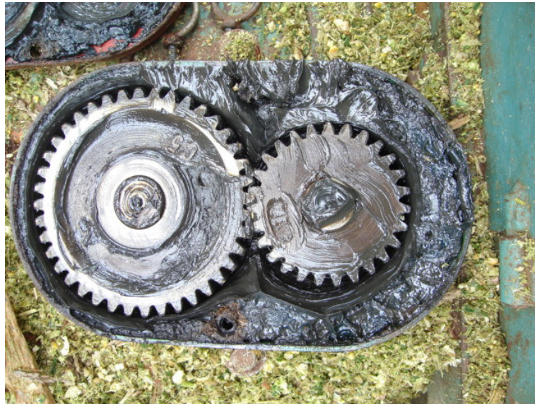
Figura 1. Engrenagens motora e movida da transmissão da colhedora de forragem.
