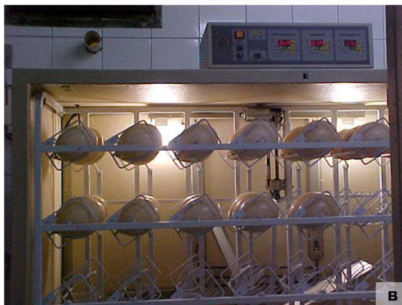
Figura 2. Sala de incubação. A. gabinete incubadora de ovos de avestruzes. B. detalhes do interior da incubadora.
