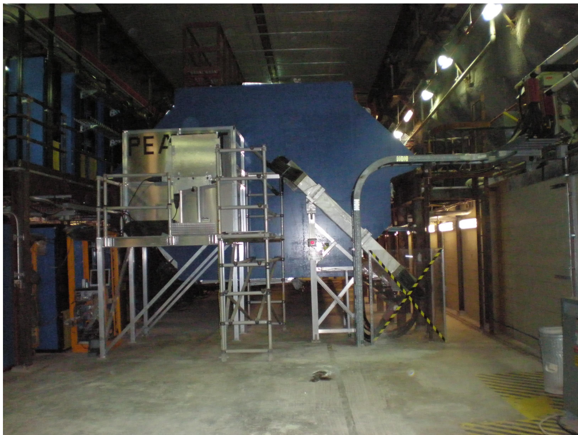
Figura 3.4: Vista da parcial da área onde ira localizar-se o detector do MINER \nu A . A estrutura visível ao fundo é o detector próximo do MINOS. O detector do MINER \nu A ocupará o espaço antes deste detector, que servirá de detector auxiliar do MINER \nu A na identificação de múons.
