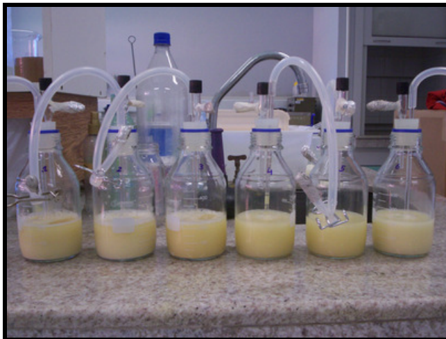
Figura 6: Biorreatores com manípulo para os ensaios de produção de hidrogênio
