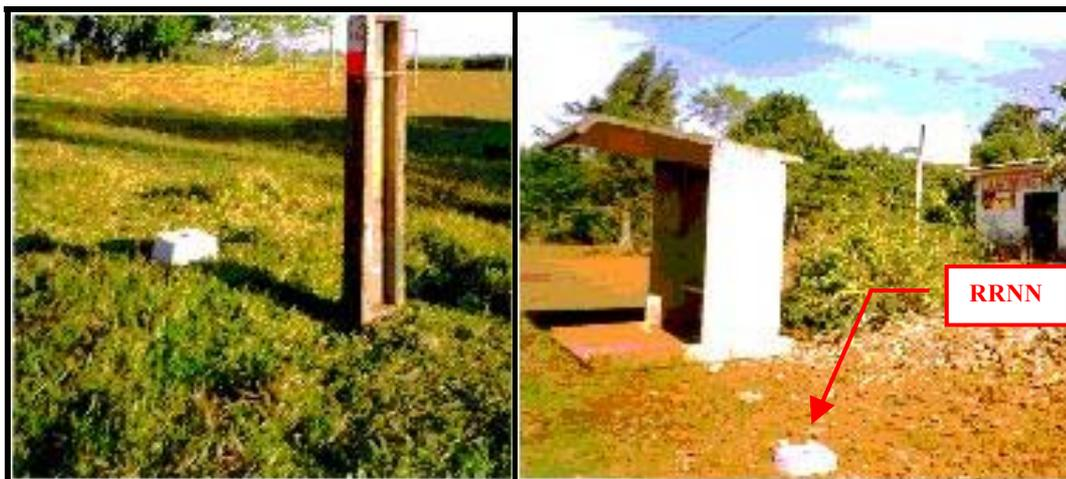
As especificações técnicas seguidas na fase de monumentação se devem ao fato de que as mudanças detectadas (em coordenadas, no caso deste trabalho) dos pontos monitorados, devem ser devidas a deslocamentos sofridos pelo ponto, sujeita à subsidência, soerguimentos em processos semelhantes, e não devido à monumentação deficiente ou imprópria.
