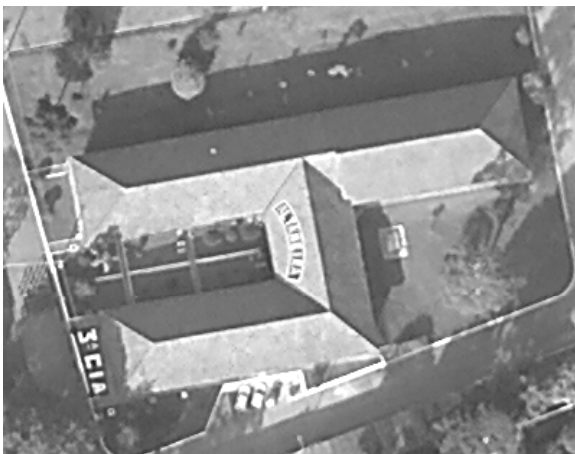
FIGURA 3.3 – EDIFICAÇÕES COM MÚLTIPLAS ÁGUAS
