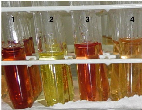
**FIGURA 5.** Quantificação de AIA utilizando o reagente de Salkowski, em que a maior tonalidade de vermelho evidencia a maior concentração de auxina. Isolados 1 – EndW57; 2 – RzW33; 3 – EndW37 e 4 – RzW35.
