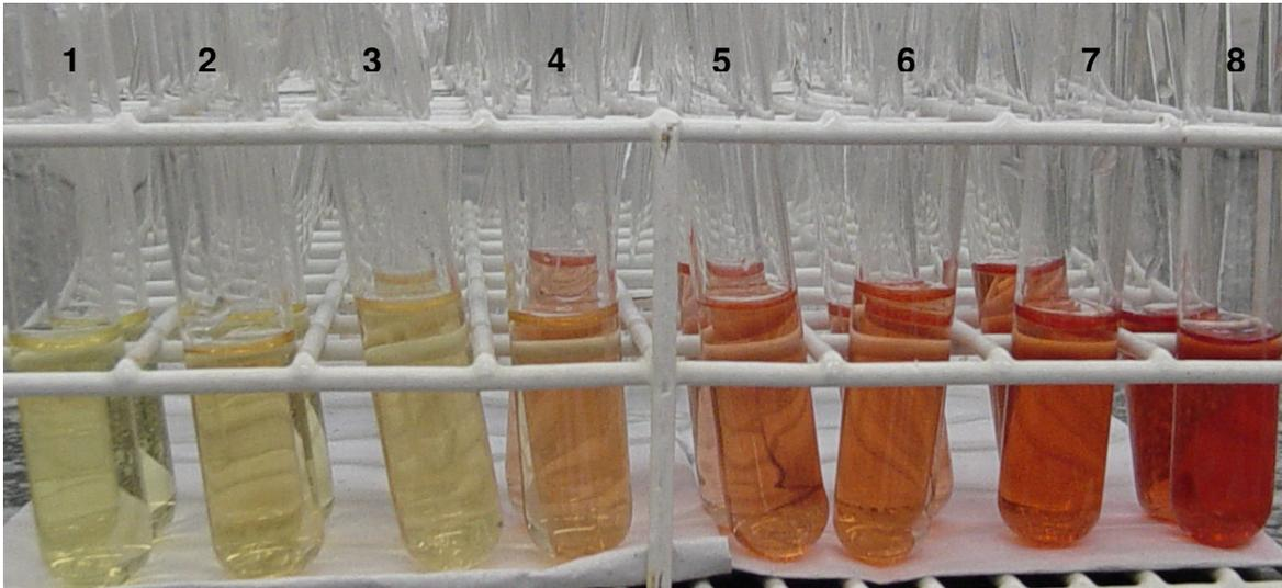
**FIGURA 4.** Padrões de concentrações de AIA comercial. 1 – Controle negativo (apenas meio Czapek e solução de Salkowski); 2 –  $1 \mu\text{g mL}^{-1}$ ; 3 –  $2 \mu\text{g mL}^{-1}$ ; 4 –  $5 \mu\text{g mL}^{-1}$ ; 5 –  $10 \mu\text{g mL}^{-1}$ ; 6 –  $25 \mu\text{g mL}^{-1}$ ; 7 -  $50\mu\text{g mL}^{-1}$ ; 8 –  $100 \mu\text{g mL}^{-1}$  de AIA.
