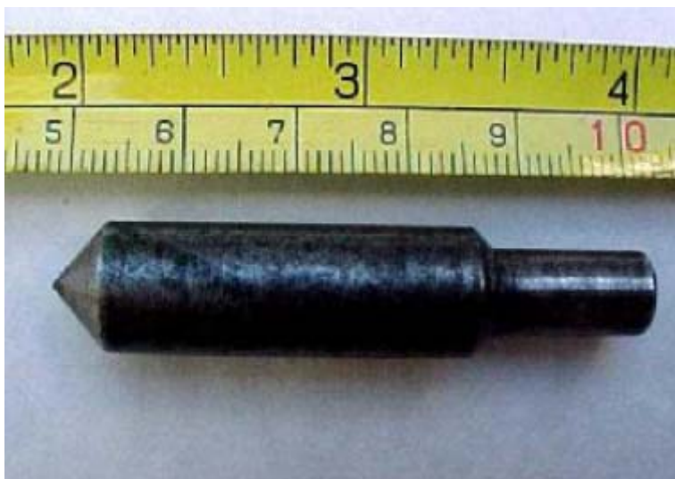
Figura 46: Ponteira de metal utilizada no ensaio CERCHAR [29]
