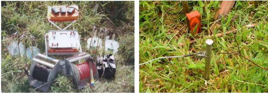
Figura 15: Equipamento ER 300 de Caminhamento elétrico, com detalhe de instalação do eletrodo no solo
