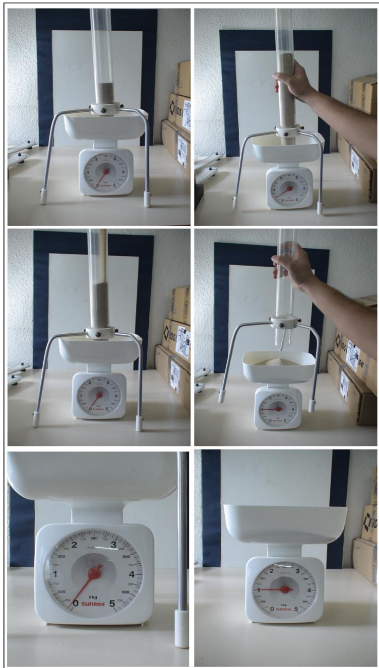
Figura 1.13: Experiência demonstrando o Efeito Janssen: em ordem cronológica, de cima para baixo, pode-se ver na coluna da esquerda o recipiente (que não encosta na balança) sendo preenchido por areia, enquanto a balança continua marcando o mesmo valor, pois o peso dos grãos é transmitido por meio de arcos de força para as laterais do recipiente. Na coluna da direita, após o recipiente ser retirado, permitindo que toda a areia se espalhe na balança, pode-se ver o medidor marcando o peso real da pilha de grãos.
