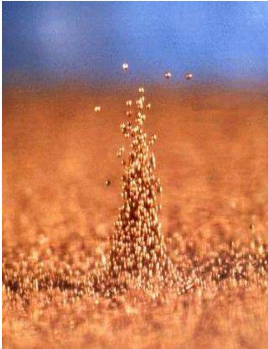
Figura 1.8: “Oscillon” obtido em uma plataforma vibrando verticalmente por Umbanhowar et al. (21).
