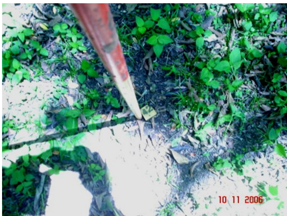
FIGURA 15: PIQUETE DE MADEIRA COM IDENTIFICAÇÃO, CRAVADO AO NÍVEL DO TERRENO.
