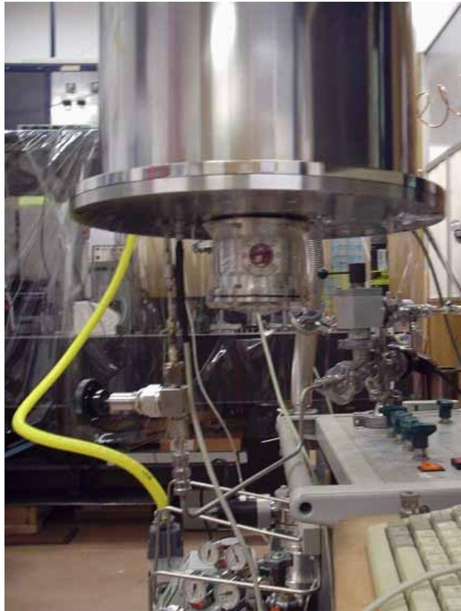
Figura 3.8: Montagem concluída do nosso aparato experimental ainda sem os sistemas ópticos. Em destaque, a peça inteiriça de alumínio que é adaptada na chapa externa do criostato.
