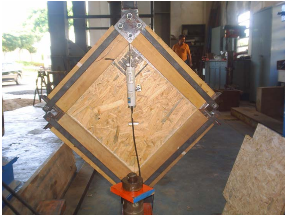
Figura 4-16 – Posicionamento dos transdutor de deslocamento.
