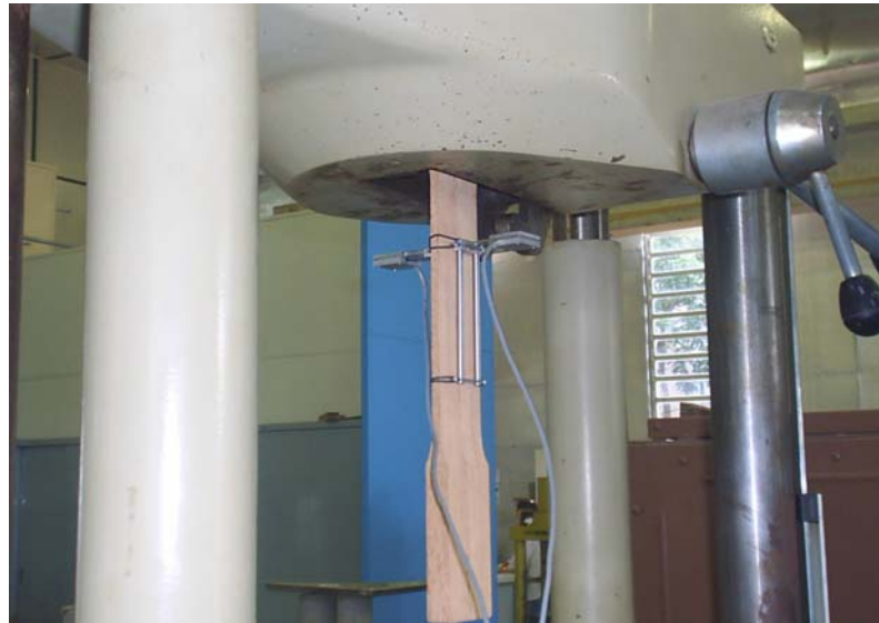
Figura 4-13 - Posicionamento do corpo-de-prova na máquina de ensaio.
