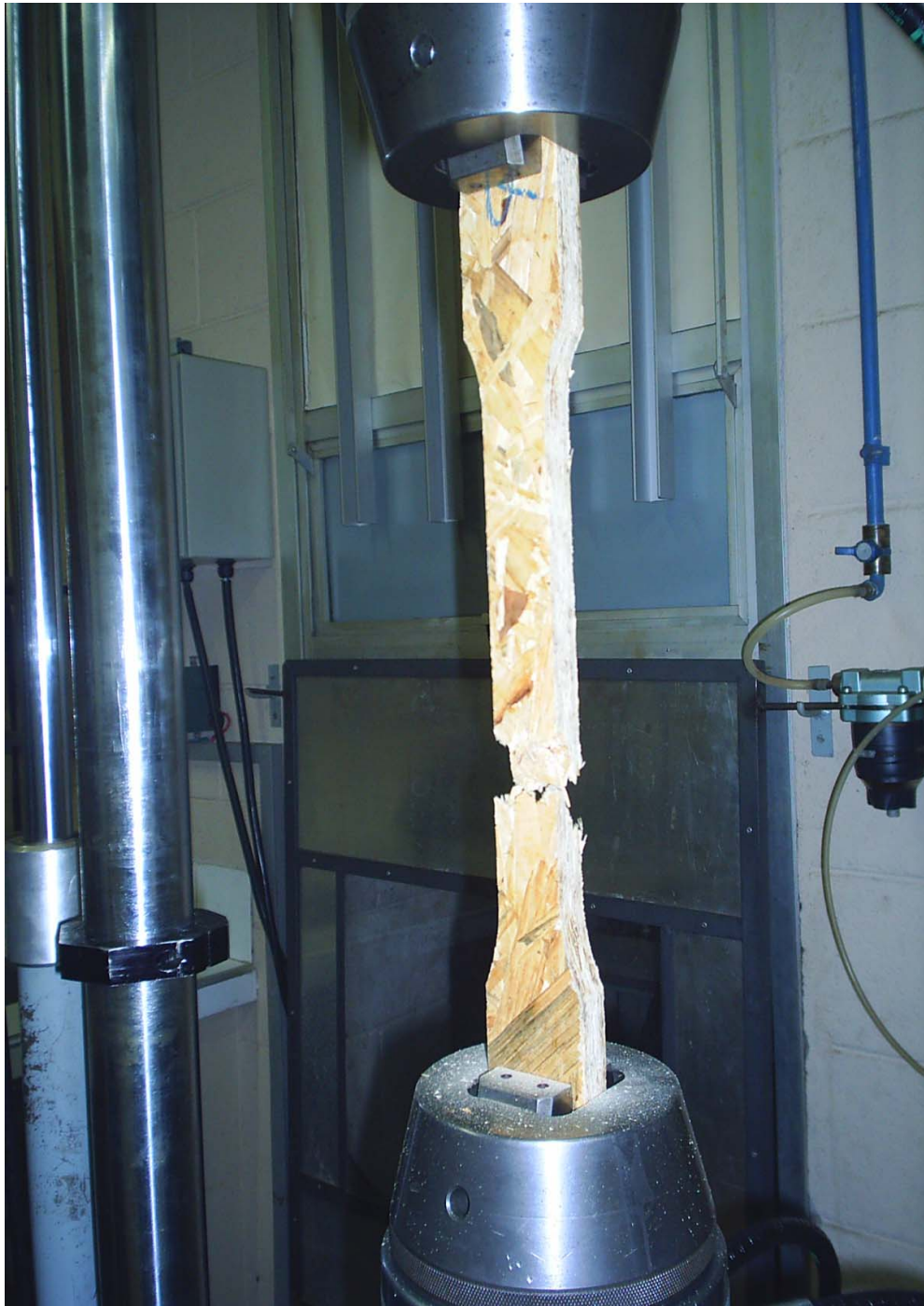
Figura 5-13 – Corpo-de-prova de tração, após ruptura .
