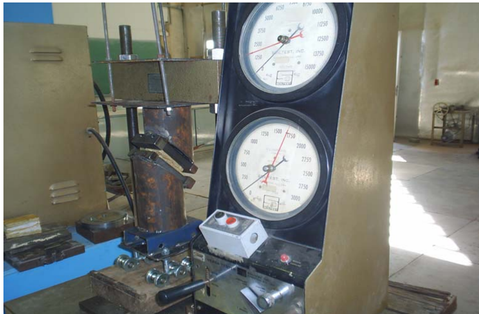
Figura 5-5- Acoplagem do sistema desenvolvido no equipamento VERSA TEST.
