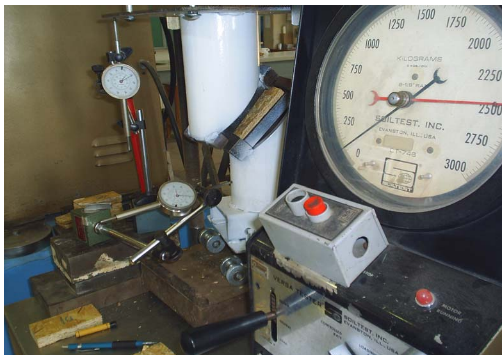
Figura 4-10– Verificação da força máxima de compressão.
