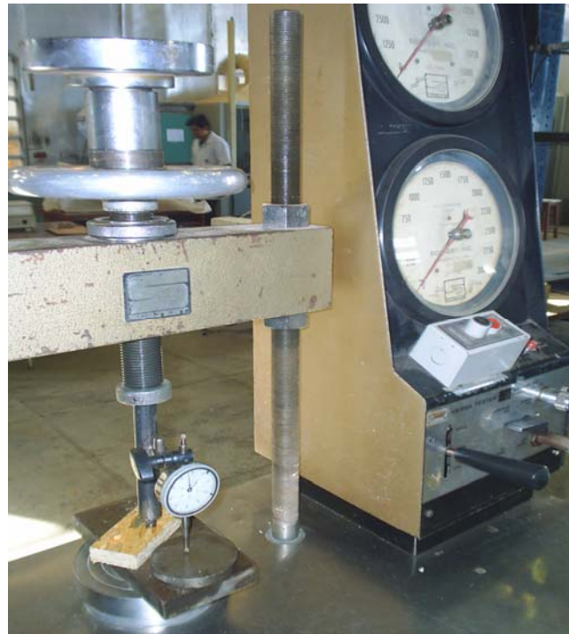
Figura 4-7 - Acoplagem do equipamento Janka na máquina universal.
