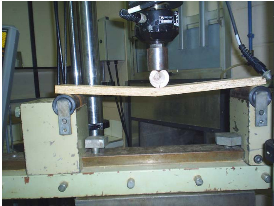
Figura 5-2 – Execução do ensaio para determinação do módulo de elasticidade (MOE) e módulo de ruptura (MOR).
