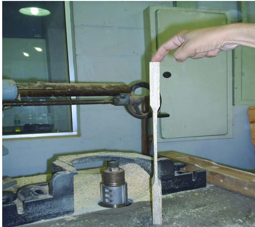
Figura 5-7 -Desgastes do eixo e do corpo-de-prova.
