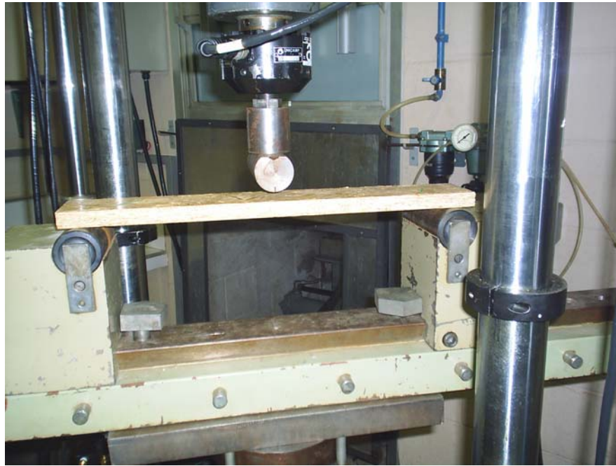
Figura 4-5 - Corpo-de-prova posicionado para ensaio de 3 pontos.
