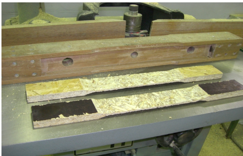
Figura 5-10 – Corpos-de-prova moldado conforme NBR 7190/97.
