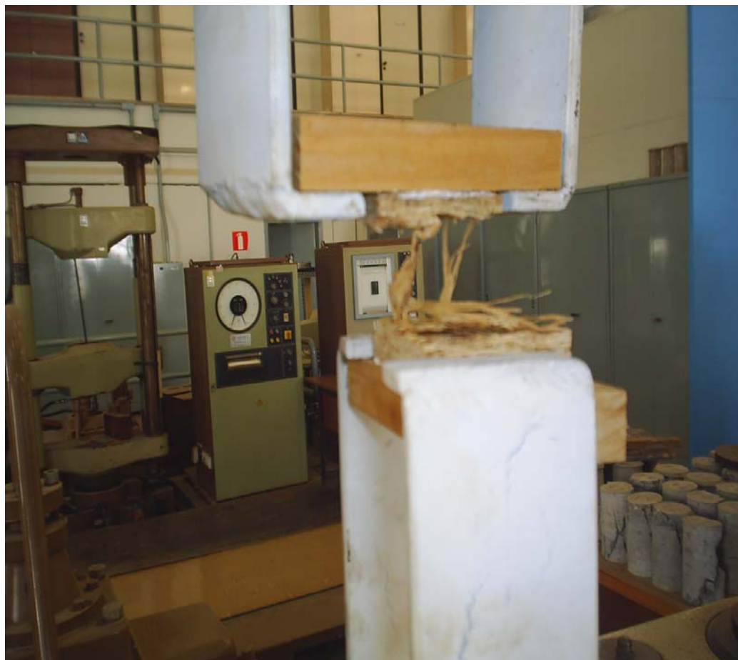
Figura 5-16– Corpo-de-prova rompido à tração perpendicular às fibras.
