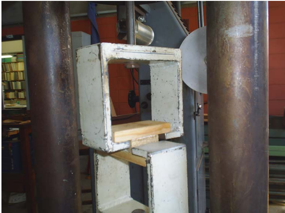
Figura 4-14 - Corpo-de-prova para tração perpendicular às fibras.
