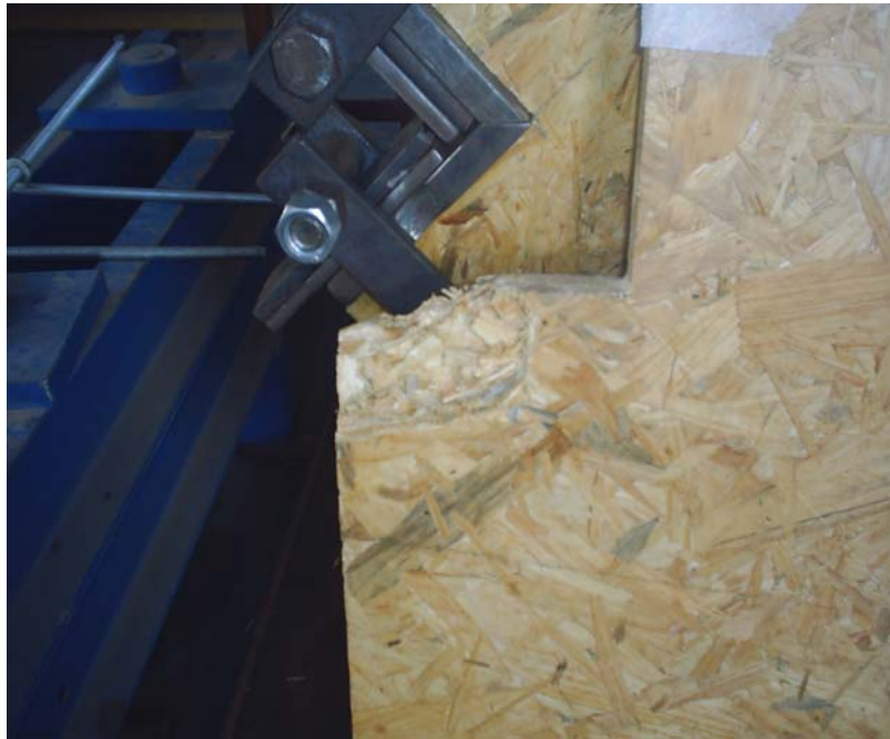
Figura 5-19- Esmagamento ocorrido nas bordas
