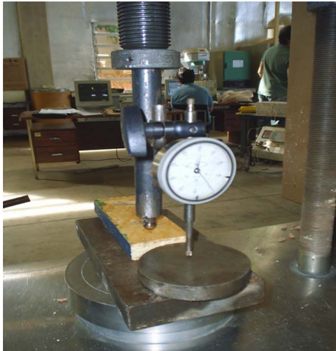
Figura 5-4 - Acoplagem a máquina da Versa Test.
