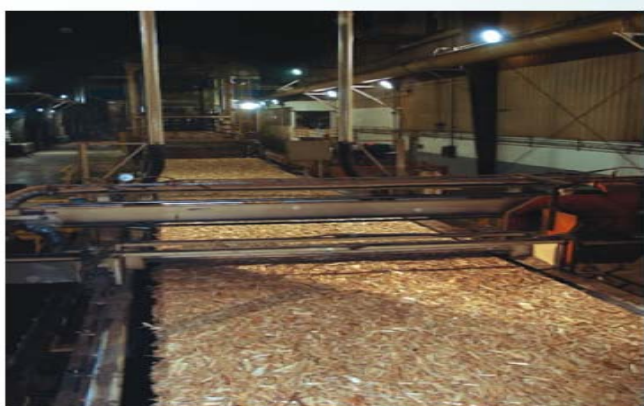
Figura 3-2 - Formação do colchão na linha de produção.
