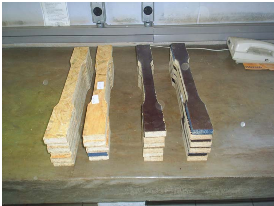
Figura 4-12 - Corpo-de-prova para tração paralela.
