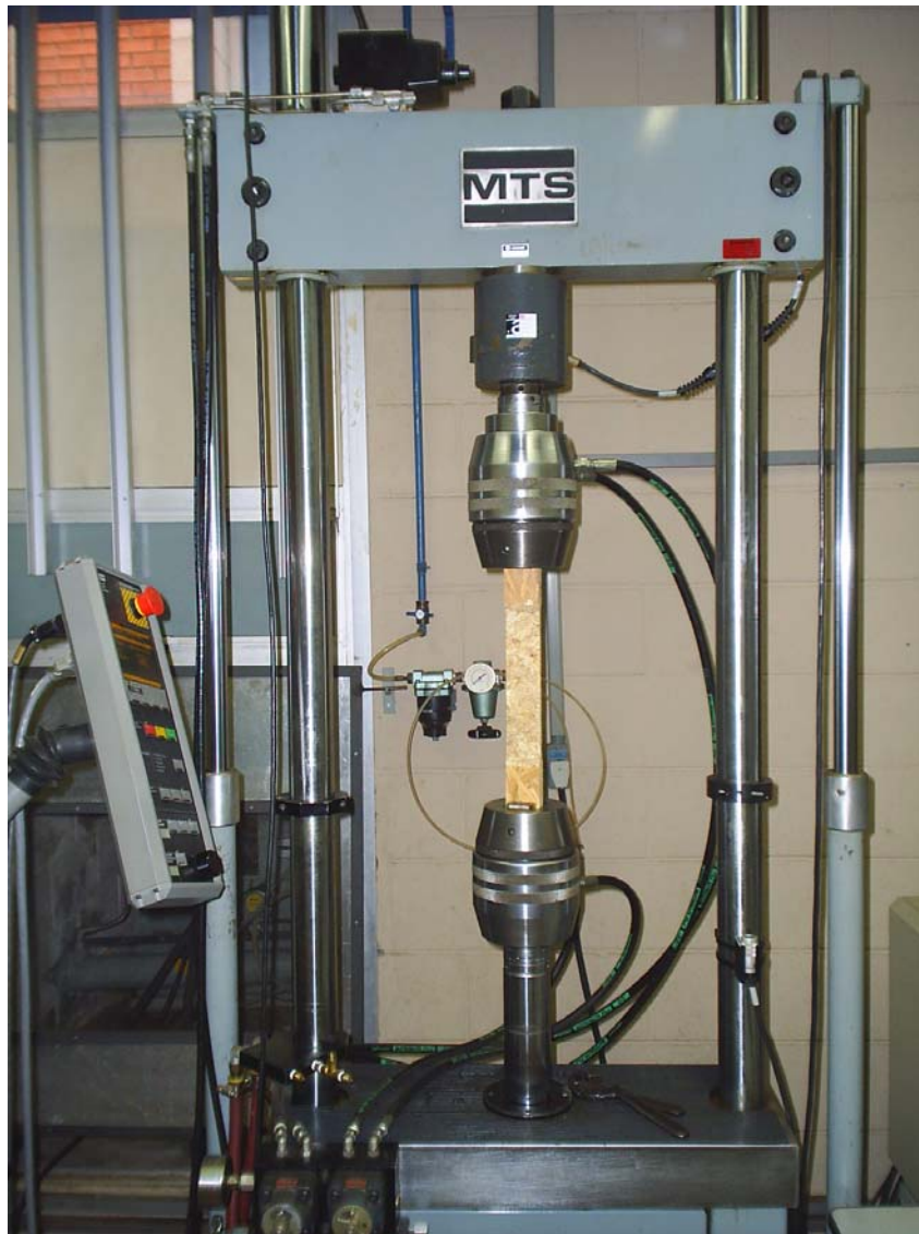
Figura 5-12 – Corpos-de-prova de tração na máquina de ensaio.
