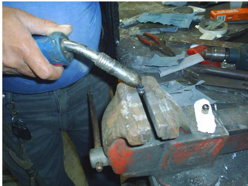
Figura 5-3 - Soldagem da esfera .
