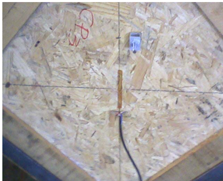
Figura 5-20 - Strain gages para aquisição da deformação.
