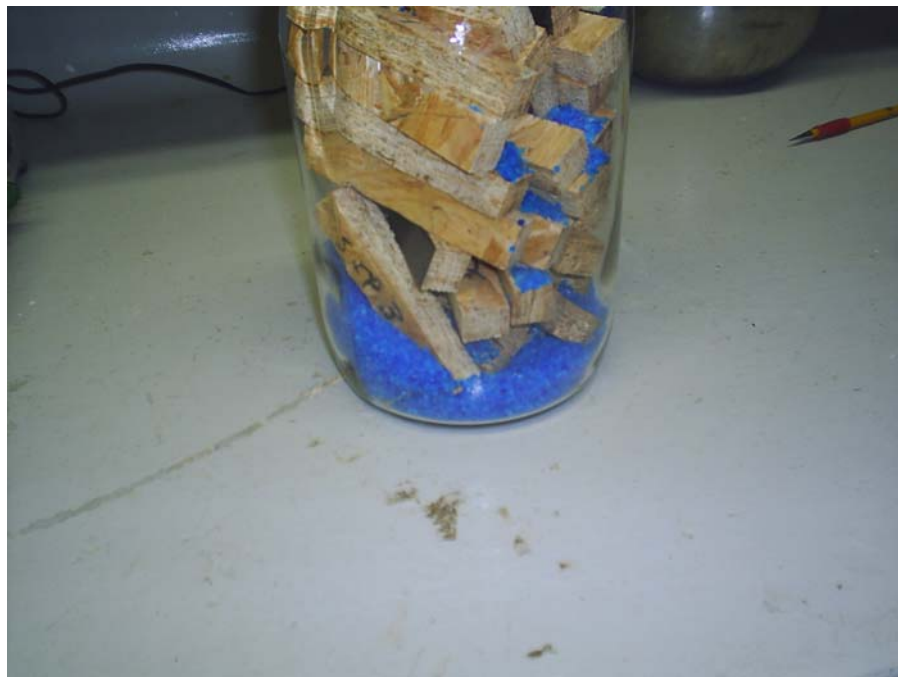
Figura 4-2 -Dessecador com desidratante, e indicador de saturação.
