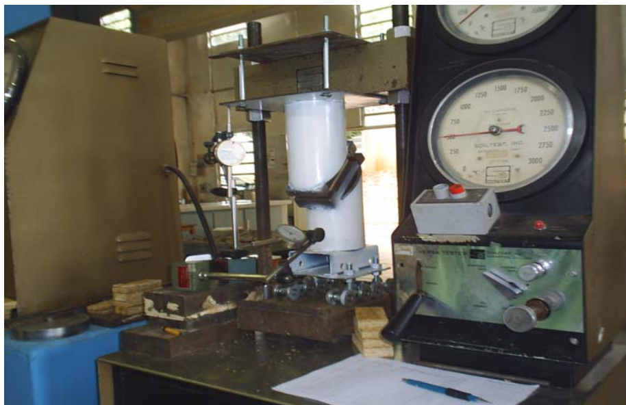
Figura 4-11 – Sistema para ensaio a compressão.
