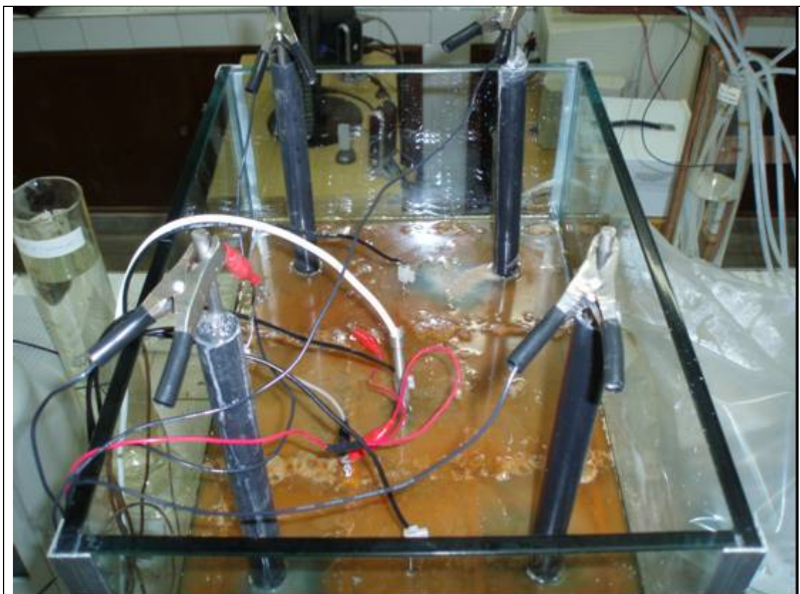
Figura 8.19 – Formação de “bolhas” na superfície do reservatório REK2 no ensaio 2.
