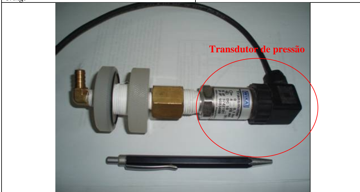
Figura 5.16 – Conjunto (transdutor de pressão + componentes de adaptação do reservatório).
