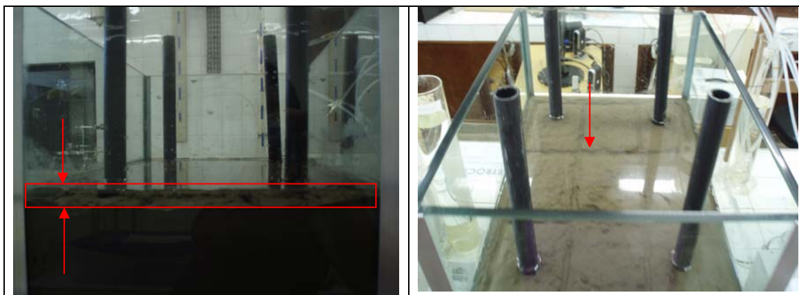
Figura 6.14 - Vista frontal do reservatório mostrando o nível d' água na superfície da amostra.
