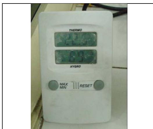
Figura 8.10 – Termômetro digital instalado no laboratório próximo ao ensaio 1 no REK2.
