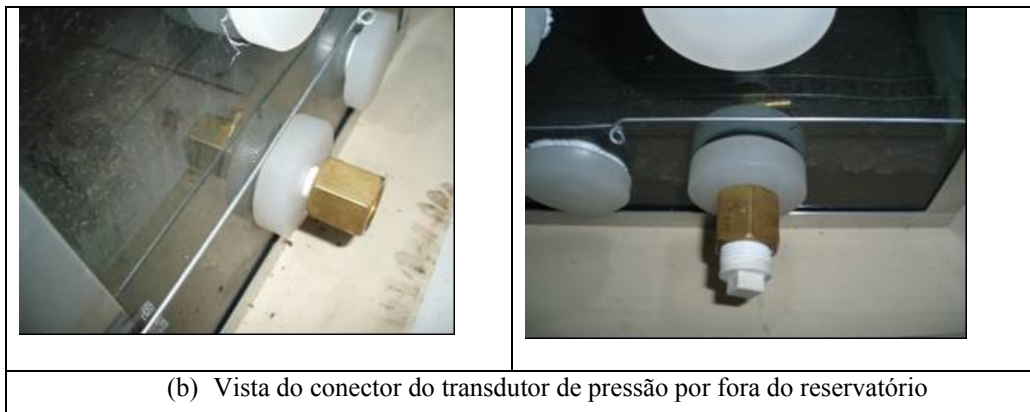
Figura 6.21 – Transdutor de pressão inserido no corpo de prova dentro do reservatório.
