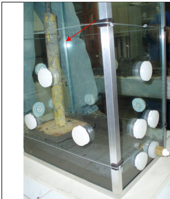
(a) Início da etapa de compactação – soquete
