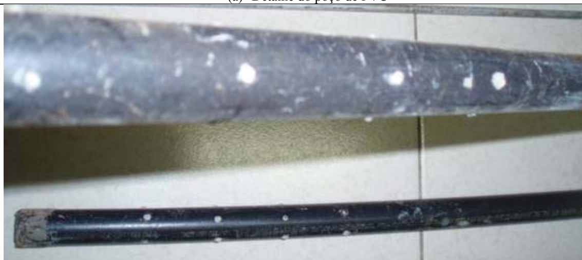
(b) Detalhe dos furos do poço de PVC
