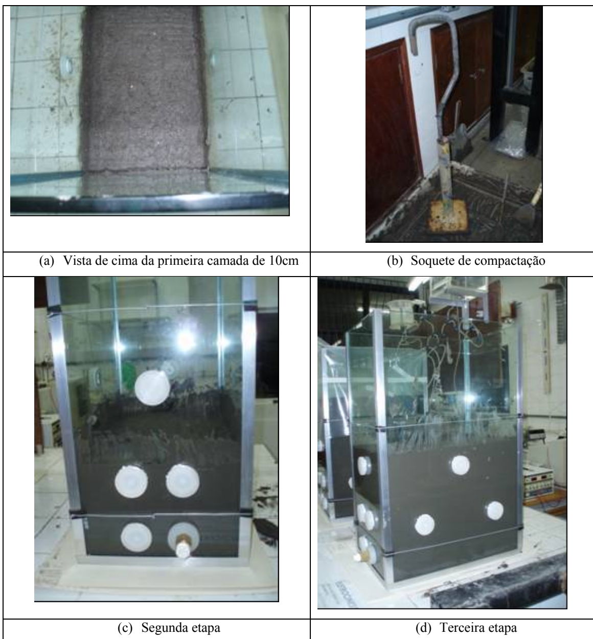
Figura 6.19 – (a) Vista de cima da primeira camada de 10cm, (b) Soquete de compactação, (c) Segunda etapa e (d) Terceira etapa.
