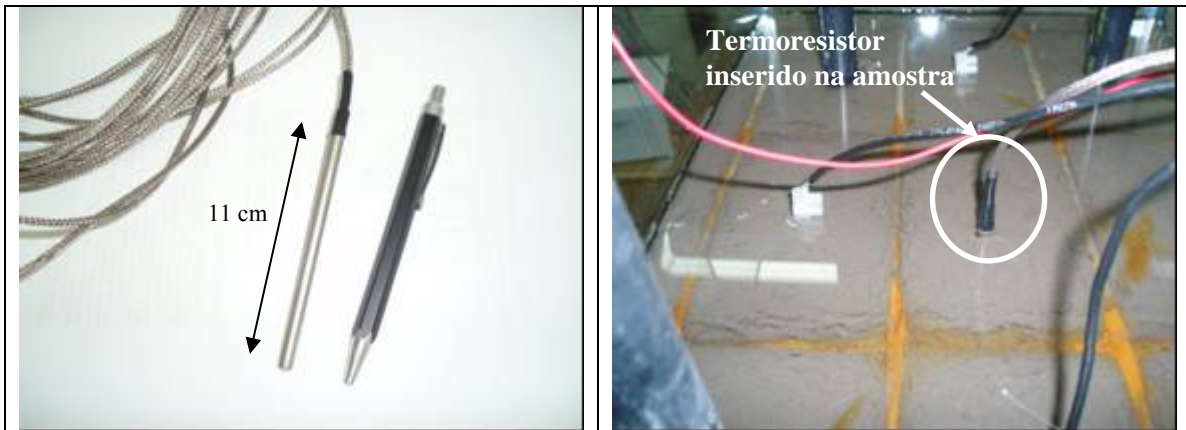
Figura 5.10 – Termoresistor PT100, (a) detalhe do termoresistor e (b) termoresistor inserido no solo.
