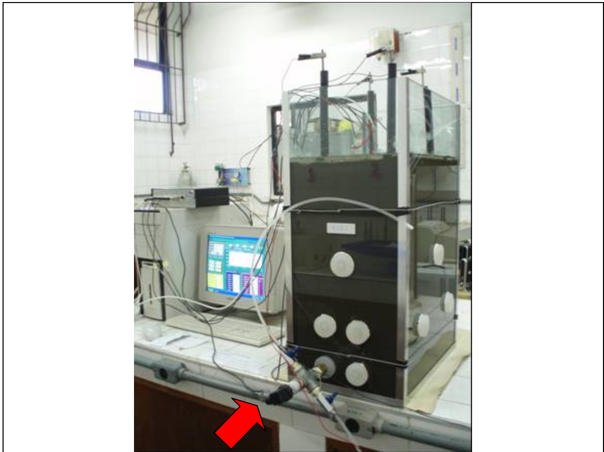
(b) - Conjunto adaptador + transdutor de pressão conectados ao reservatório.
