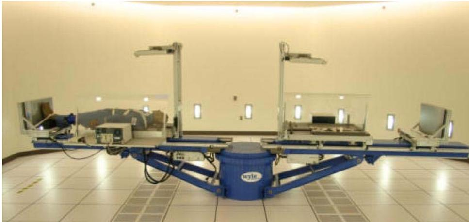
**Figura 5.3** – Centrífuga de braço curto da NASA produzida pela Wyle. O braço possui dois braços de 3 metros de comprimento e pode atingir até 5G.
