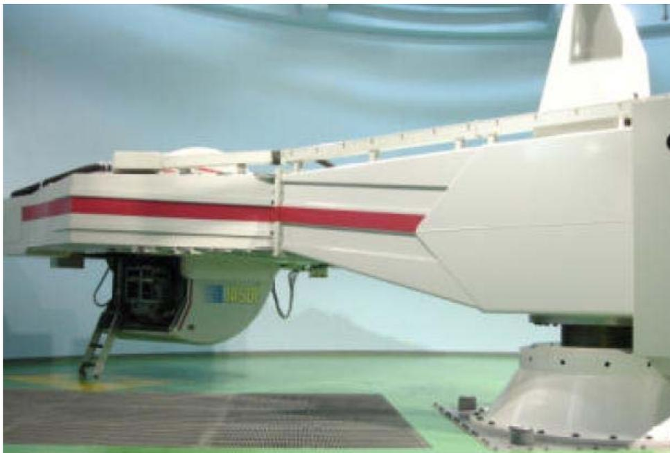
**Figura 5.1** – Centrífuga japonesa JASDF (Japan Air Self Defense Force), braço com 7,62m, 6G/sec, +Gz máximo 12G, 9G é força utilizada para treinamento. Em torno de 200 pilotos treinados por ano (9).
