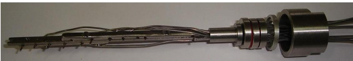
Figura 4.1.5 – Sonda II montada com seus 10 termopares
