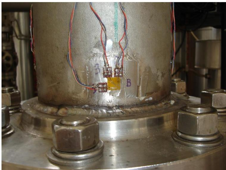
Figura 4.1.13 – Detalhe de extensômetro com seus cabos
