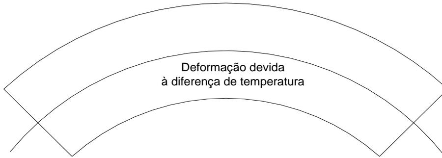
Figura 1.2 – Deformação longitudinal do tubo devida à diferença de temperatura
