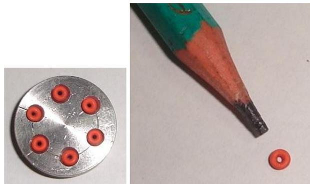
Figura 4.1.3 – Disco com anéis de vedação para termopares – sonda III
