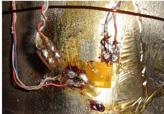
Figura 6.4.1 – Extensômetro deteriorado
