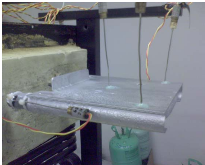
FIGURA 3.4 – Termopares 3 e 4 na aleta do evaporador.
