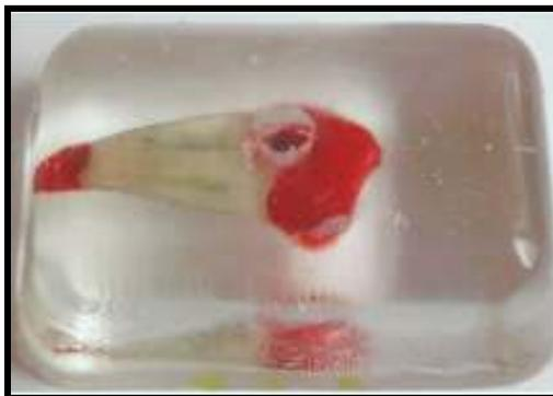
**FIGURA 6 – Amostra incluída em resina**
