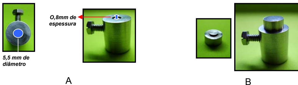
FIGURA 3 – A- Matriz utilizada para a confecção dos corpos-de-prova para os testes de sorção e solubilidade; B- Dispositivo empregado para regular as matrizes, padronizando o tamanho das amostras em 5,5 de diâmetro por 0,8 mm de espessura.
