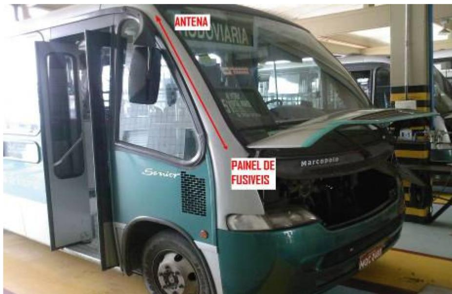
**Figura 14 – Instalação do módulo AVL**
