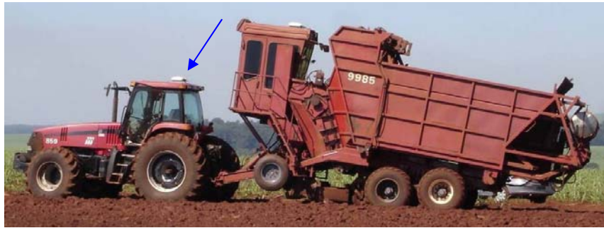
Figura 9 - Trator fazendo simulação de plantio, guiado por piloto automático; os receptores de GPS testados estavam instalados sobre a cabine do trator
