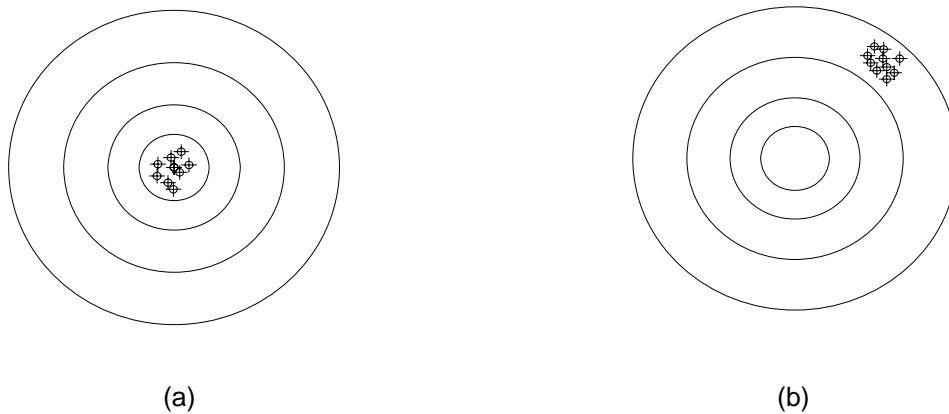
Figura 2 - Representação de uma condição de alta acurácia e alta precisão (a) e baixa acurácia e alta precisão (b)
