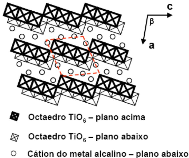
Figura 1.2: Esquema mostrando a estrutura lamelar do titanato  $Na_2Ti_3O_7$ . Figura retirada da referência [2].
