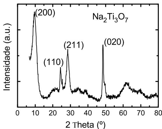
Figura 2.4: Difratograma de R-X dos TNTs para os sintetizados no Laboratório de Nanomateriais - UFMG.
