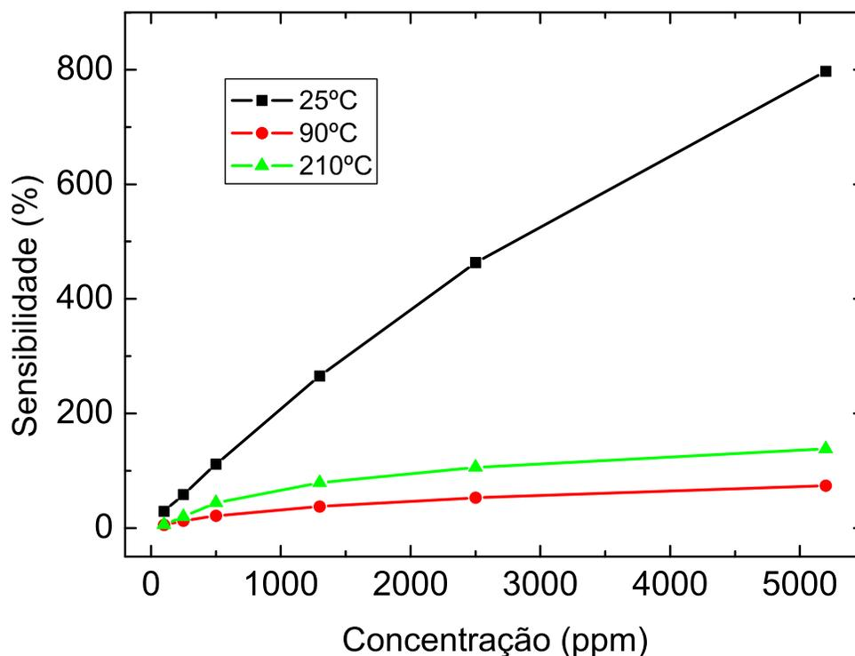
Figura 3.4: Sensibilidade em função da concentração de  $H_2$  para três temperaturas.
