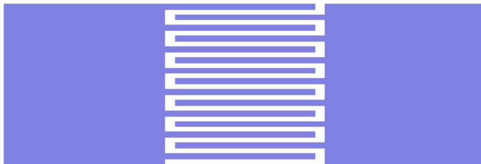
Figura 2.9: Geometria dos contatos interdigitados..
