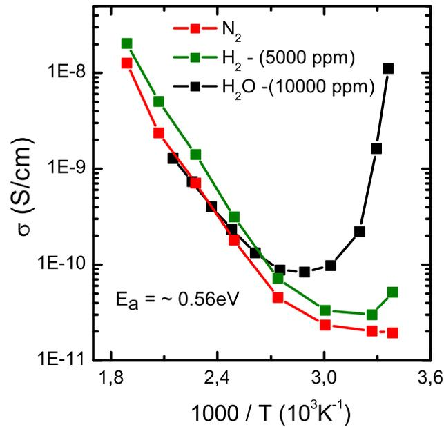
Figura 3.6: Gráfico de Arrhenius da condutividade dos filmes determinada sob três atmosferas diferentes. O dispositivo exposto somente ao gás base, exposto a 5000 ppm de  $\text{H}_2$  e exposto a 10000 ppm de água.
