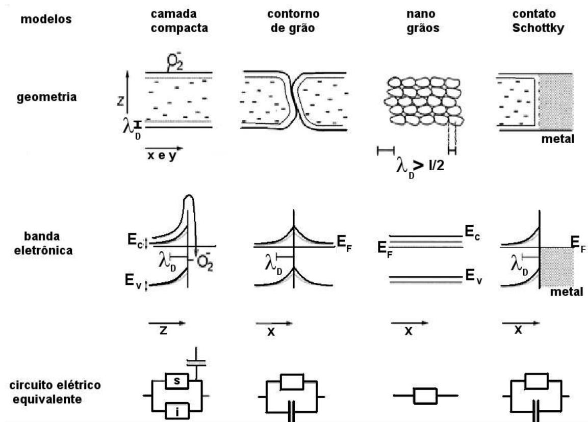
Figura 1.5: Diferentes modelos de camadas e respectivas representações da geometria, estrutura de bandas e circuito elétrico equivalente.  $E_c$ ,  $E_v$ ,  $E_F$  e  $\lambda_D$  correspondem a energia fundo da banda de condução, topo da banda de valência, energia de Fermi e comprimento de Debye respectivamente. Figura modificada da referência [3].
