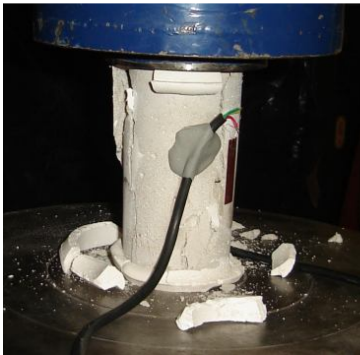
Figura 5.17 - Modo de ruptura dos corpos-de-prova de argamassa.
