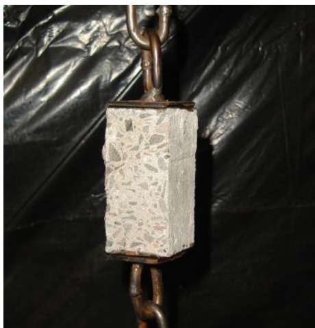
Figura 5.10 - Amostra de parede do bloco fixada nos elementos especiais.
