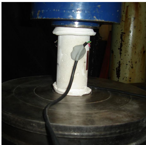
Figura 5.14 - Corpo-de-prova preparado para receber carregamento.
