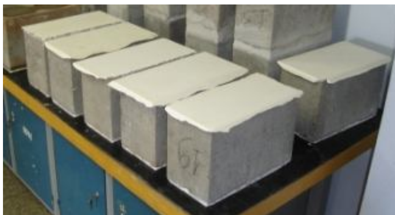
Figura 5.2 - Blocos vazios capeados em ambas as faces sem instrumentação
