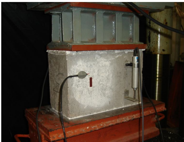
Figura 5.5 - Bloco instrumentado durante ensaio de carregamento
