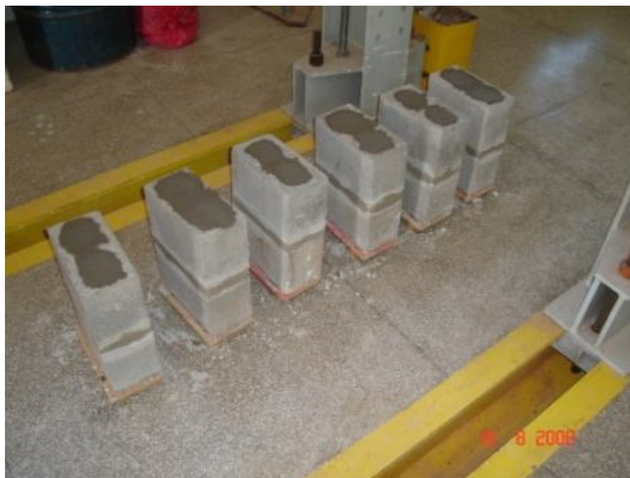
Figura 5.26 - Prismas assentados com argamassa A2 e cheios de graute (PR2-A2-G1).
