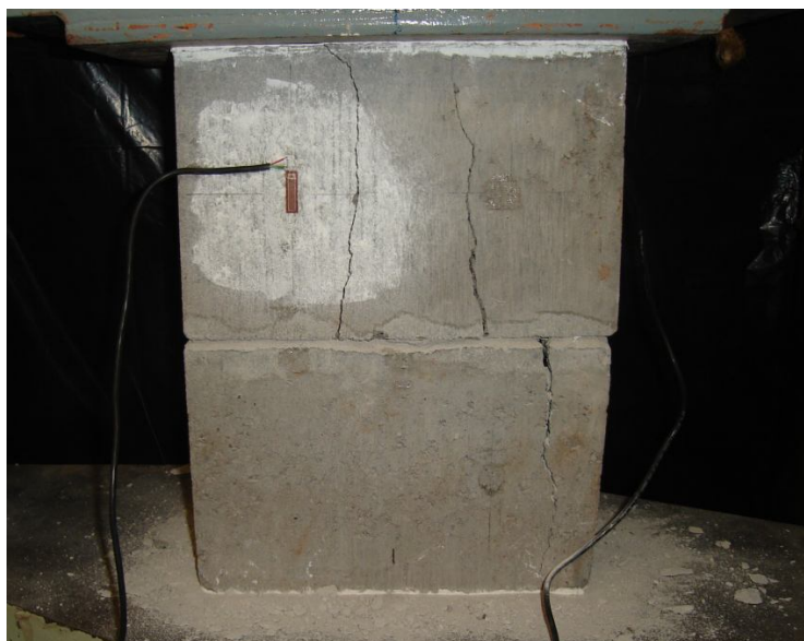
Figura 5.30 - Modo de ruptura do prisma PR2-A01.
