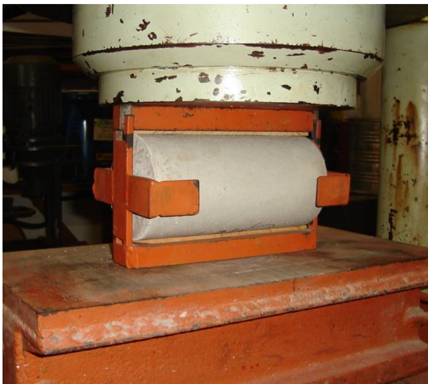
Figura 5.23 - Ensaio de compressão diametral em CP de graute.
