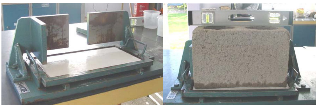
Figura 5.1 - Capeamento dos blocos
