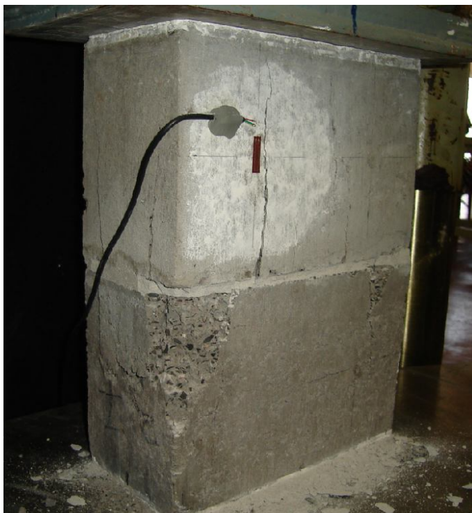
Figura 5.31 - Modo de ruptura do prisma PR2-A02.
