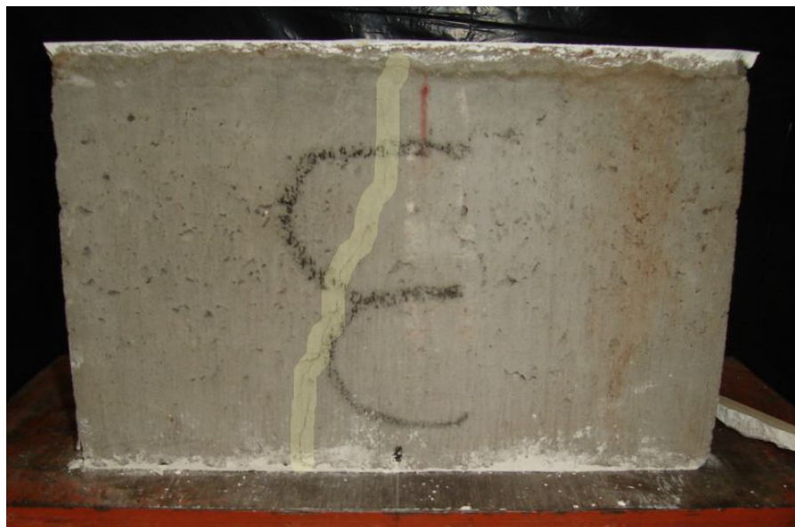
Figura 5.9 - Modo de ruptura dos blocos vazios
