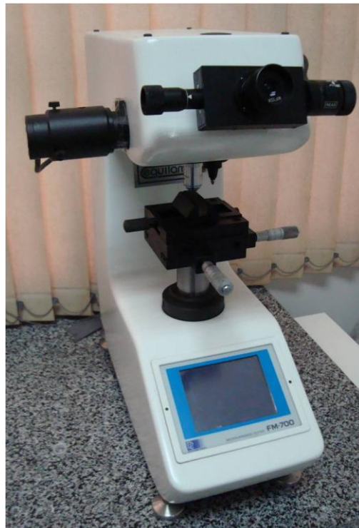
Figura 9- Microdurômetro Microhardness Tester FM 700 do Departamento de Odontologia Restauradora da FOSJC-UNESP.
