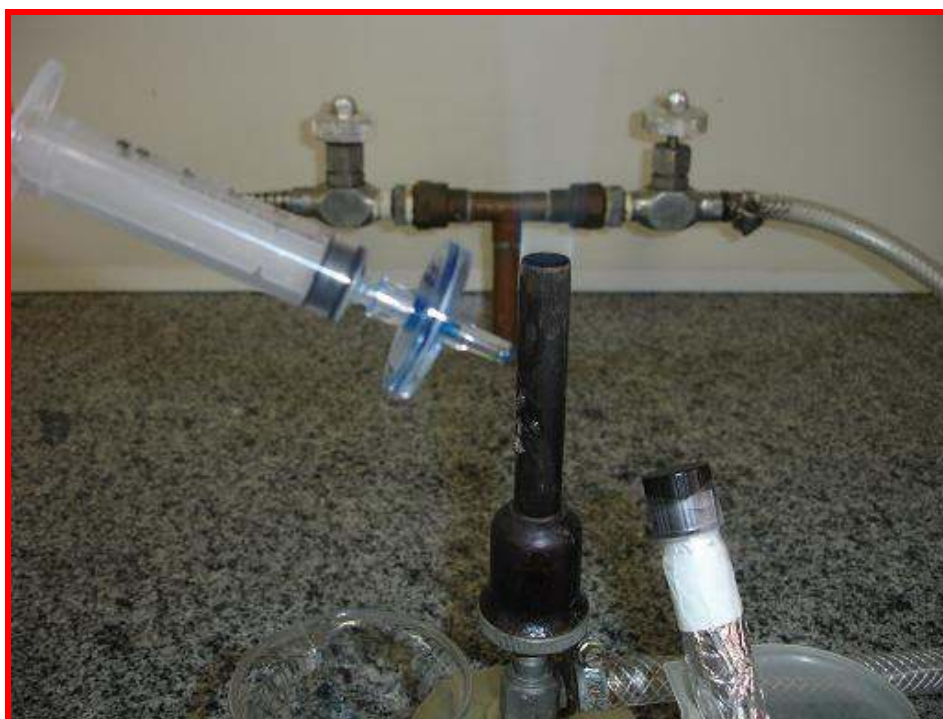
Figura 5 – Esterilização da solução de Azul de Metileno por filtração
