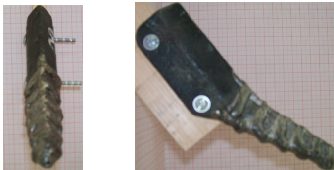
Figura 16 – Colocação da soldagem de revestimento transversal do conjunto 2.
