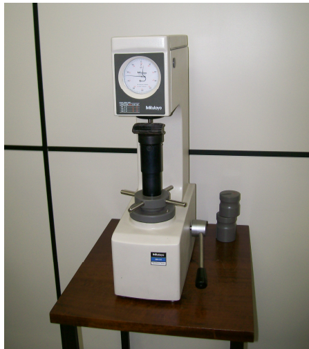
Figura 22 – Durômetro utilizado na verificação da dureza da ponteira original.
