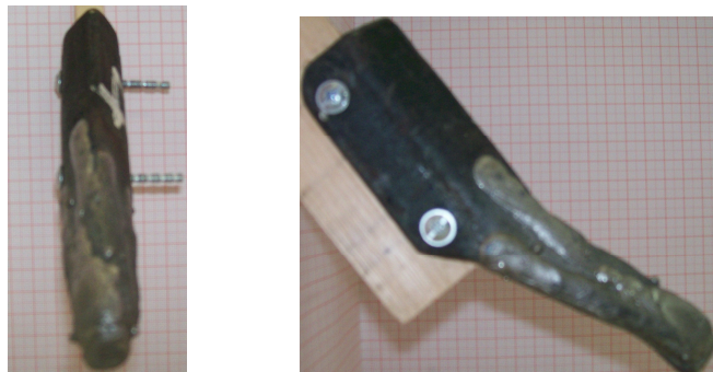
Figura 18 – Colocação da soldagem de revestimento longitudinal do conjunto 4.
