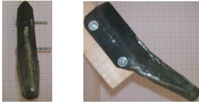
Figura 17 – Colocação da soldagem de revestimento longitudinal do conjunto 3.
