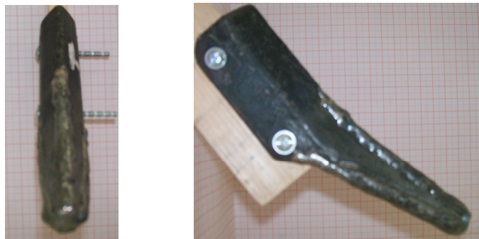
Figura 15 – Colocação da soldagem de revestimento longitudinal do conjunto 1.
