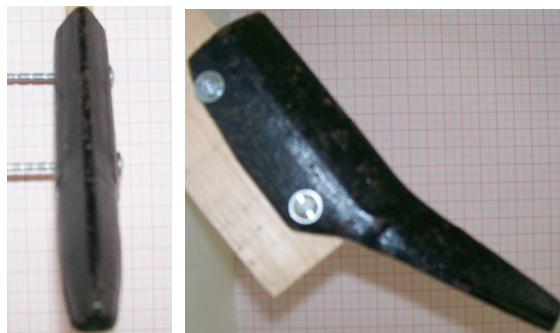
Figura 20 – Ponteira testemunha sem soldagem de revestimento.
