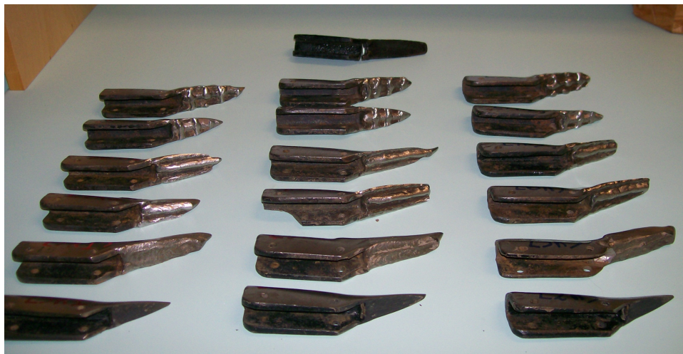
Figura 32 – Parte posterior das ponteiros com 52,5km de deslocamento.
