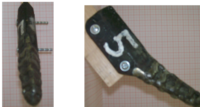
Figura 19 – Colocação da soldagem de revestimento transversal do conjunto 5.
