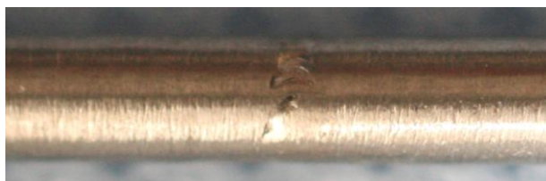
FIGURA 10 – Falhas no preenchimento na região de solda LASER.
