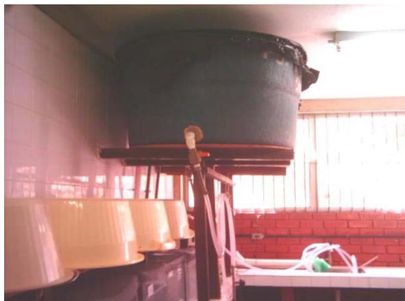
Figura 1 - Caixas d'água utilizadas para abastecer os recipientes de polietileno
