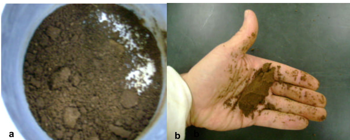
Figura 14 – Aparência do solo no estado de consistência friável, com teor de água de 0,10 \text{ kg.kg}^{-1} (10%): a) antes de ser manipulado; b) quando manipulado com a mão.
