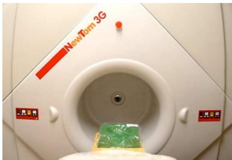
Figura 6 - O conjunto caixa e crânio foram posicionados no centro do portal de entrada do tomógrafo ( gantry ) antes do escaneamento,.
