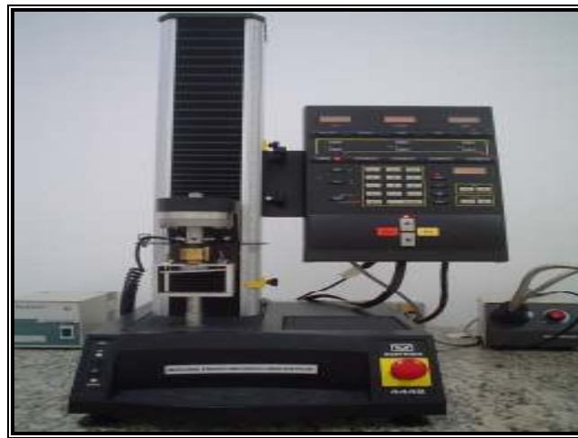
FIGURA 12 - Máquina universal de ensaio Mini-Instron, modelo 4442.
