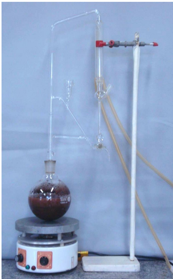
Figura 4.1 Sistema utilizado na extração do óleo essencial dos frutos da Pimenta dioica Lindl.
