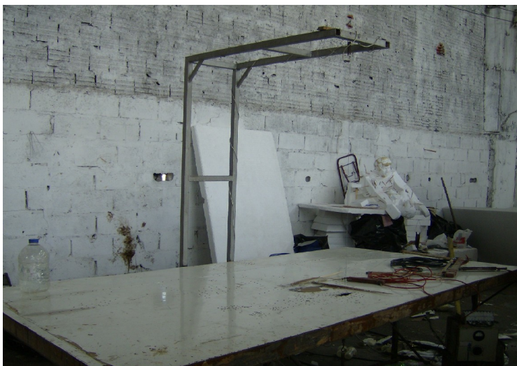
Fig. 43 - Mesa de corte para isopor utilizado na maioria das escolas de samba, Rosas de Ouro 2006.
