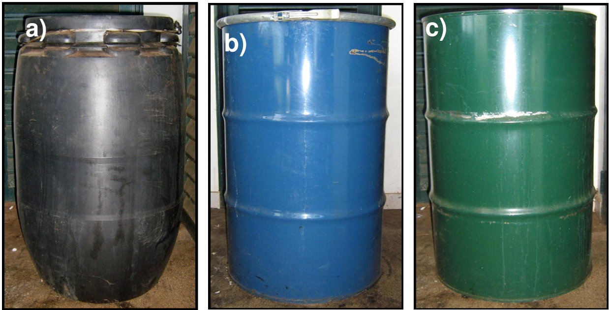
Figura 20 a) Tanque preto de P.E.A.D., b) Tanque azul de aço carbono com revestimento interno de expóxi fenólico, c) Tanque verde de aço carbono sem revestimento.
