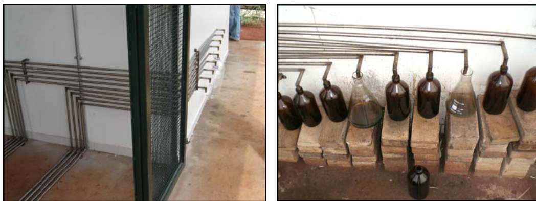
Figura 19 Sistema de coleta das frações de destilação do produto craqueado. (Da ref. 8 ).
