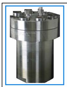
Figura 9. Reator de aço (autoclave).
