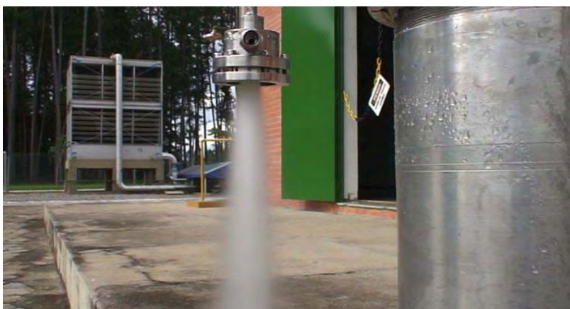
Figura 2.42 – Teste de qualificação do injetor bipropelente utilizando água destilada, com funcionamento dos canais de oxidante.
