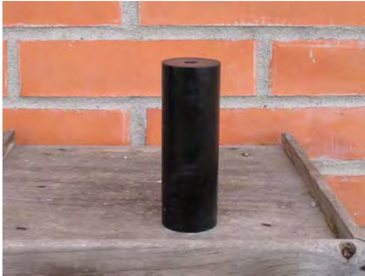
Figura 2.10 – Grão de parafina utilizado nos testes de baixa pressão.
