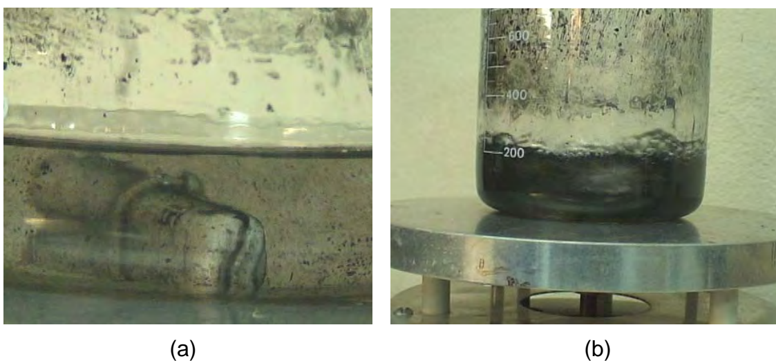
Figura 2.3 – Agitador magnético utilizado para homogeneizar a mistura de parafina com negro de fumo. (a) Estático; (b) Em movimento.
