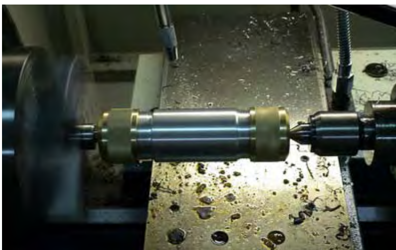
Figura 2.5 – Torno mecânico utilizado na preparação do grão de parafina.
