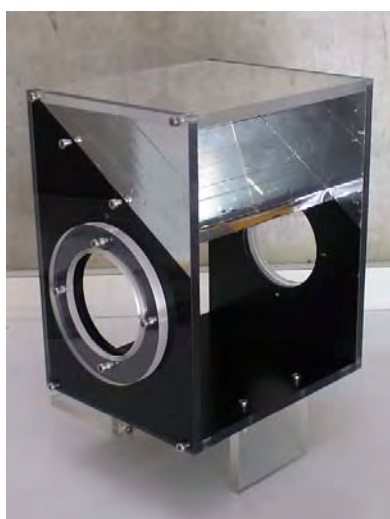
Figura 2.24 – Caixa de acrílico utilizada para o alojamento dos vidros de borossilicato não temperado.
