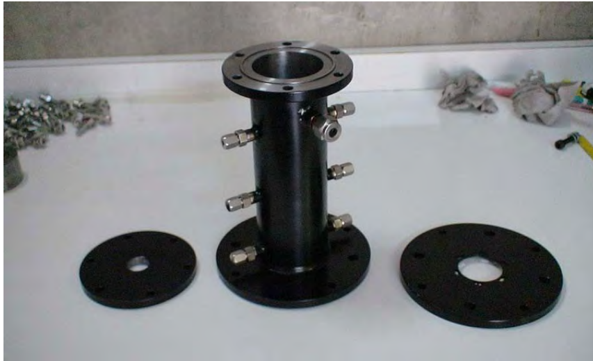
Figura 2.46 – Protótipo do propulsor híbrido de 70 N.
