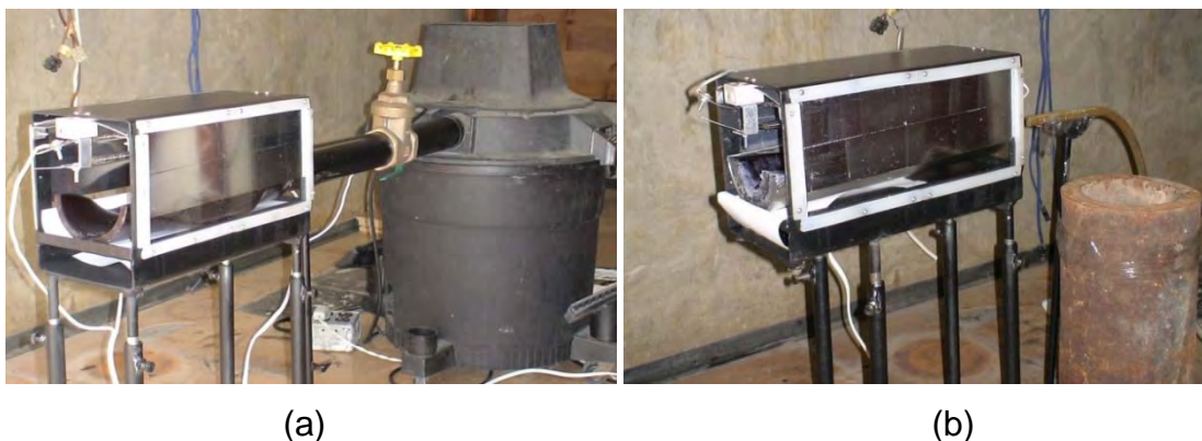
Figura 2.18 – Sistema para a geração de gotas de parafina. (a) Utilizando um soprador de ar; (b) Utilizando ar comprimido.
