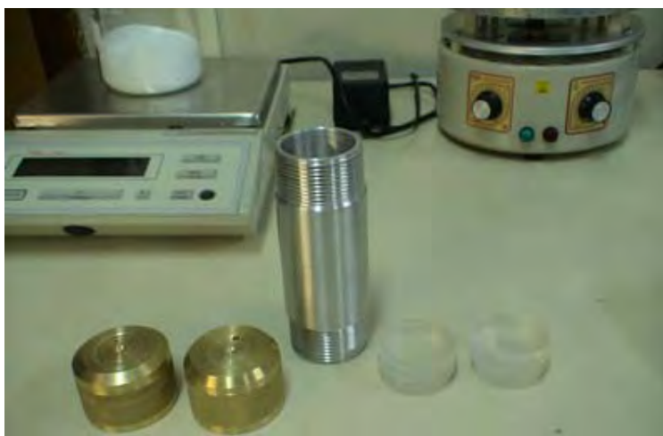
Figura 2.4 – Tampas de latão (esquerda), forma cilíndrica de alumínio (centro) e tampões de acrílico (direita).
