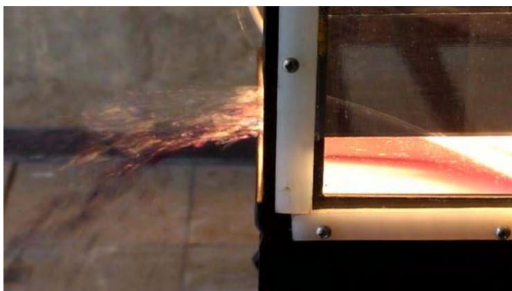
Figura 2.19 – Geração de gotas de parafina utilizando um Soprador de ar.
