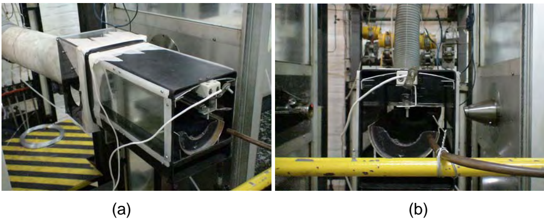
Figura 2.27 – Bancada de testes do sistema de geração e medição de gotas de parafina. (a) Vista em Perspectiva; (b) Vista Frontal. (IPT-USP).
