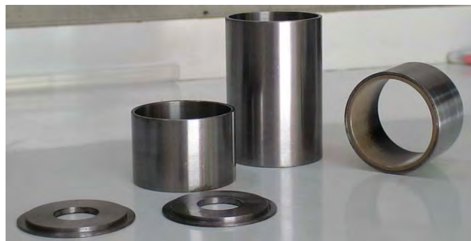
Figura 2.49 – CÂMARA DE COMBUSTÃO, PRÉ-CÂMARA, PÓS-CÂMARA E TAMPAS DE VEDAÇÃO, FABRICADAS EM AÇO CARBONO.
