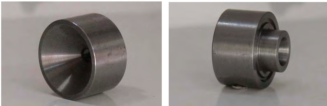
Figura 2.47 – TUBEIRA DE NÍOBIO, (a) VISTA DA SEÇÃO CONVERGENTE; (b) VISTA DA SEÇÃO DIVERGENTE.
