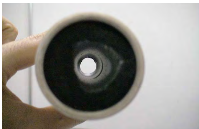
Figura 2.6 – Grão cilíndrico de parafina com negro de fumo.
