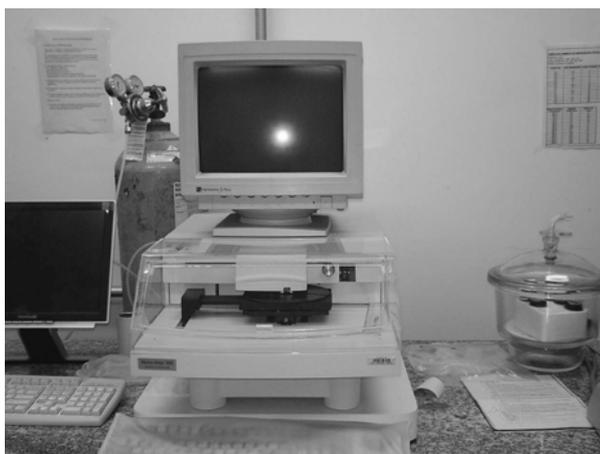
FIGURA 2.20: Vista frontal do perfilômetro Alpha-Step 500 da Tencor instalado no LAS/INPE.
