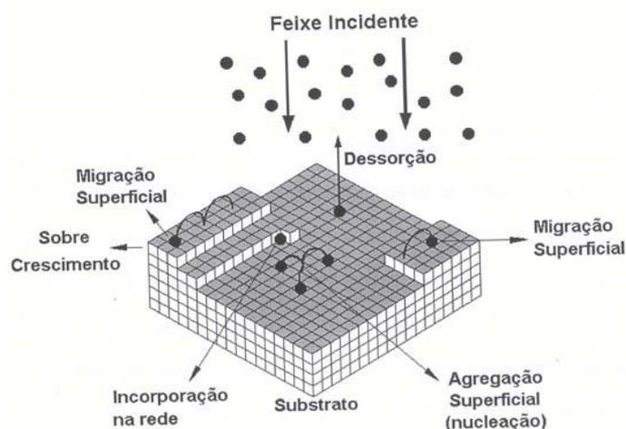
FIGURA 2.1: Ilustração dos processos que ocorrem na camada próxima de transição (CPT), junto à superfície do substrato durante o crescimento por MBE. Fonte: Boschetti (2000) e Rappl (1998).
