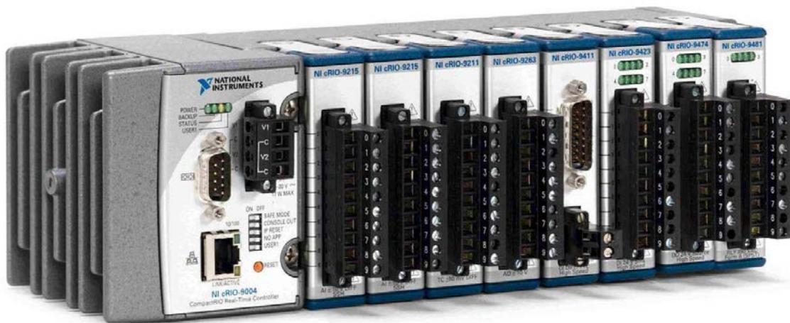
FIGURA 5.2 – CompactRIO com capacidade para 8 módulos de E/S.
