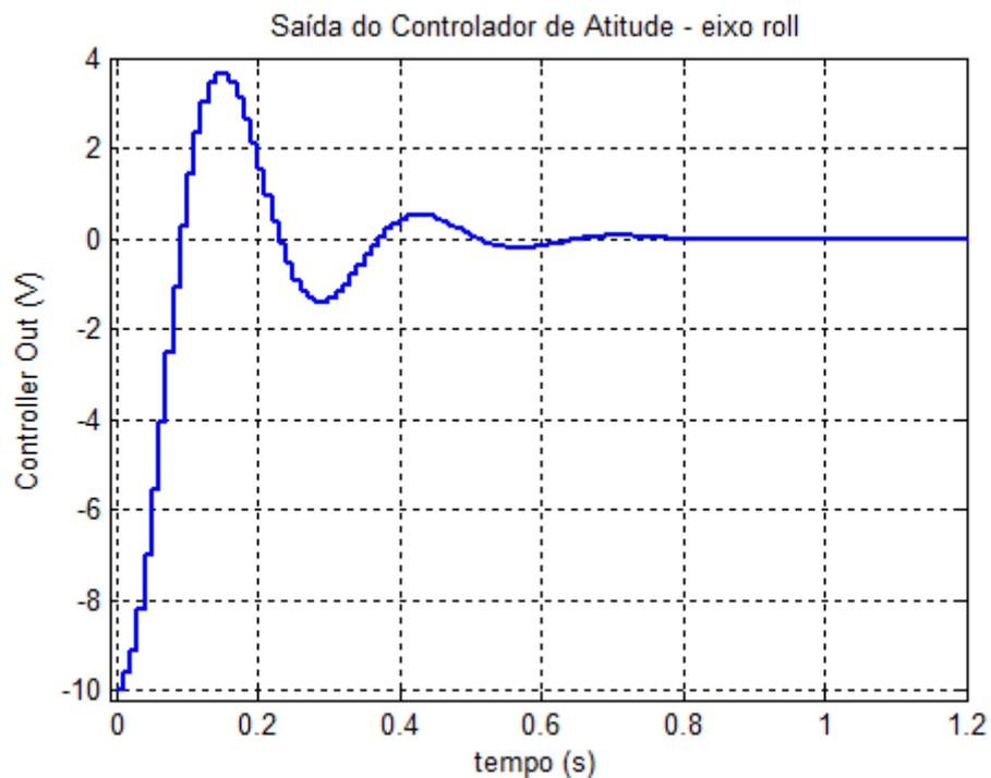
FIGURA 4.28 – Saída do controlador de atitude, eixo de “roll”, para uma manobra pequena. Detalhe realçando a resposta de curta duração.
