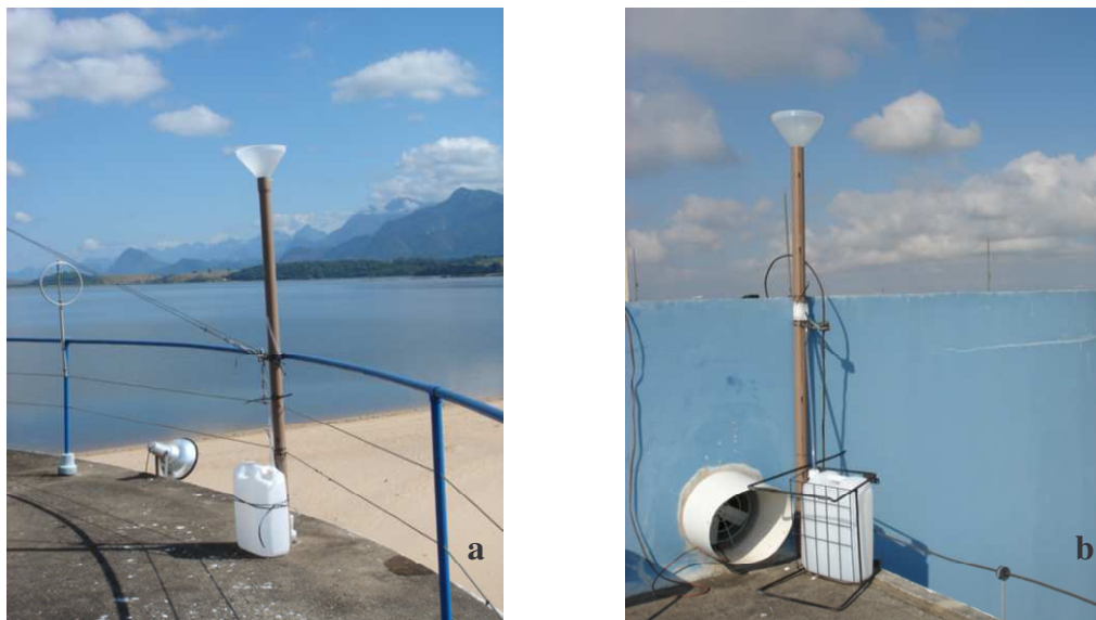
Figura 14: Foto ilustrativa do local e dos coletores de deposição total (a) Lagoa de Cima e (b) UENF.
