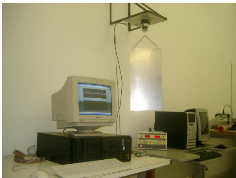
Figura 3.10: Experimento usado para obter o torque de reação
