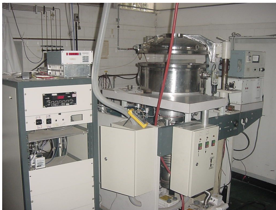
FIGURA 3.3. Sistema por magnetron sputtering para deposição de filmes de AlN e de filmes funcionais de TiN e de AlN.
