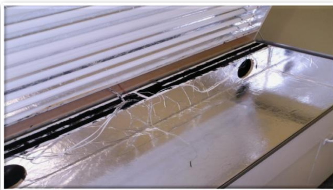
Figura 4.1 – Visão interna da versão preliminar da câmara de fotoestabilidade, contendo seis lâmpadas BF e duas lâmpadas UV.
