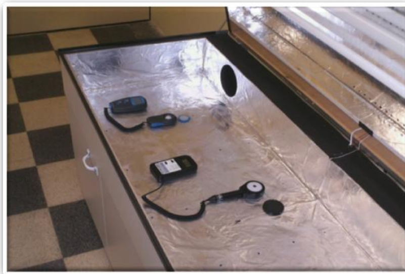
Figura 4.6 – Ilustração da posição dos detectores do radiômetro e luxímetro nos pontos demarcados na câmara de fotoestabilidade.
