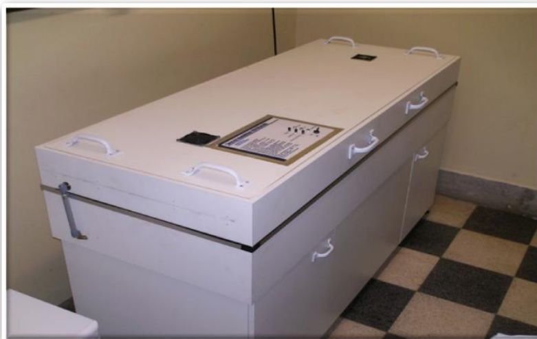
Figura 4.4 – Visão geral da câmara de fotoestabilidade construída pelo Núcleo de Pesquisas em Nutrição Parenteral.
