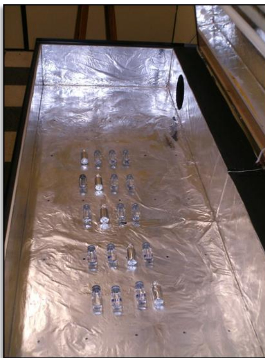
Figura 4.12 – Exposição das formulações de NP na câmara de fotoestabilidade.
