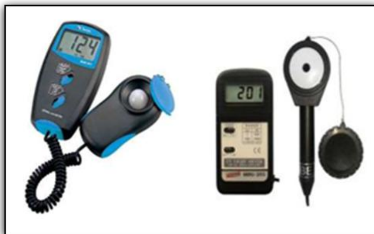
Figura 2.1 – Actinômetros físicos: luxímetro (esquerda) e radiômetro (direita).
