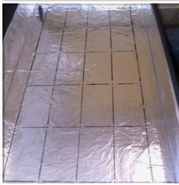
Figura 4.5 – Delineamento da área útil na superfície de exposição das amostras dentro da câmara de fotoestabilidade.
