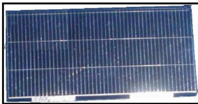
FIGURA.4.13- Célula de silício utilizada para calibração do sistema.
