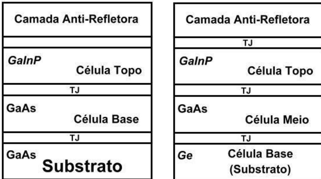
FIGURA 3.4- Comparação esquemática da célula de DJ (GaInP/GaAs) com a célula TJ (GaInP/GaAs/Ge).
