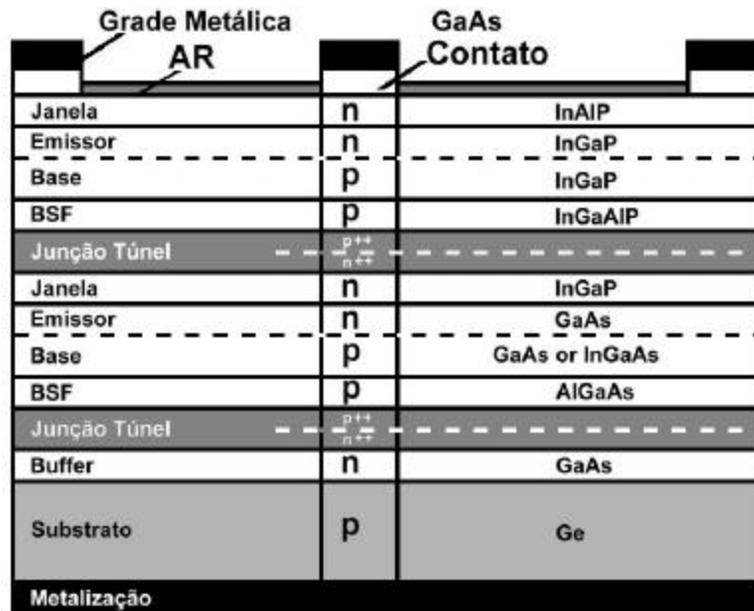
FIGURA 3.10- Diagrama esquemático da célula ATJ.
