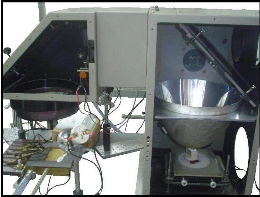
FIGURA 4.3- Foto do simulador solar para teste de células tripla junção.
