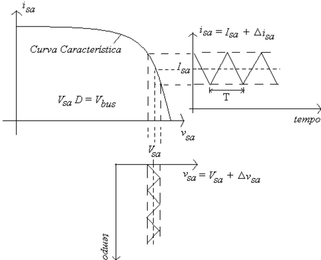
**FIGURA 2.11** - Operação da planta do sistema com duty cycle constante.
