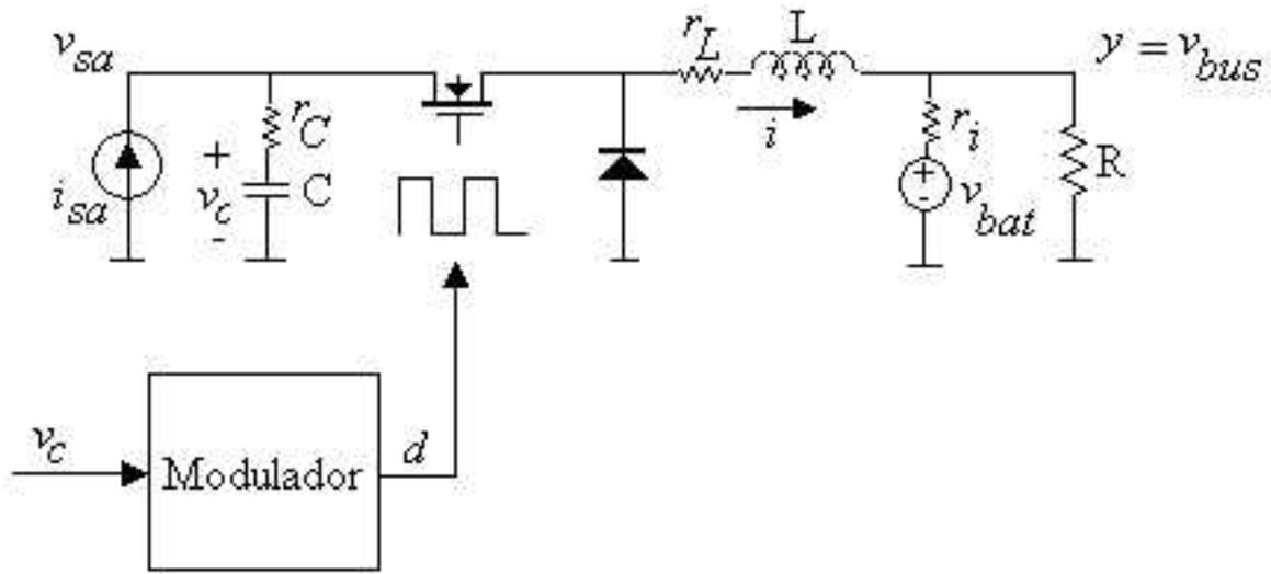
FIGURA 3.8 - Diagrama elétrico da planta com resistências parasíticas.
