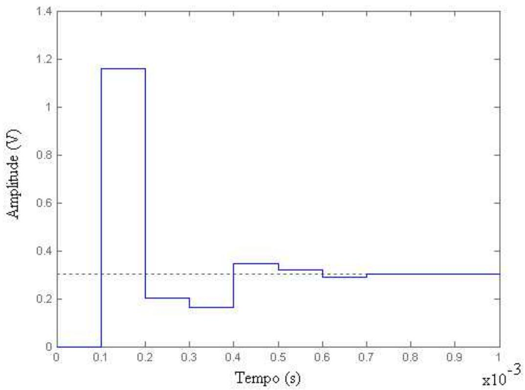
FIGURA 3.18 - Resposta da planta a um degrau para tempo de amostragem  $T_a=100\mu s$ .
