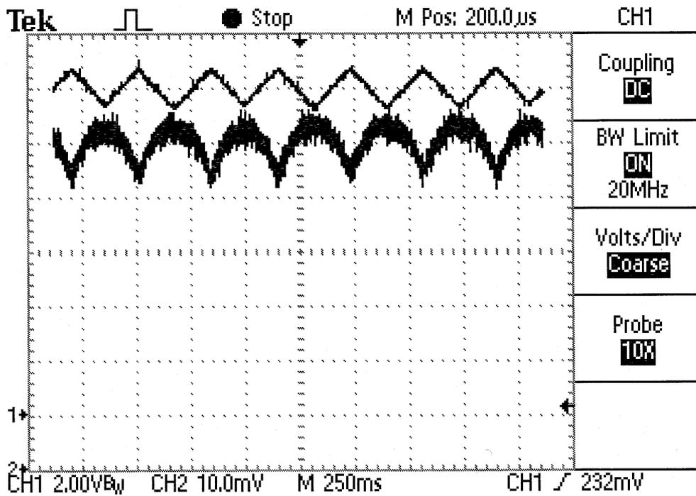
FIGURA 5.1 - CH1(curva superior, 2V/div.) é  $v_{sa}$  e CH2(curva inferior, 100mA/div.) é  $i_{sa}$ .
