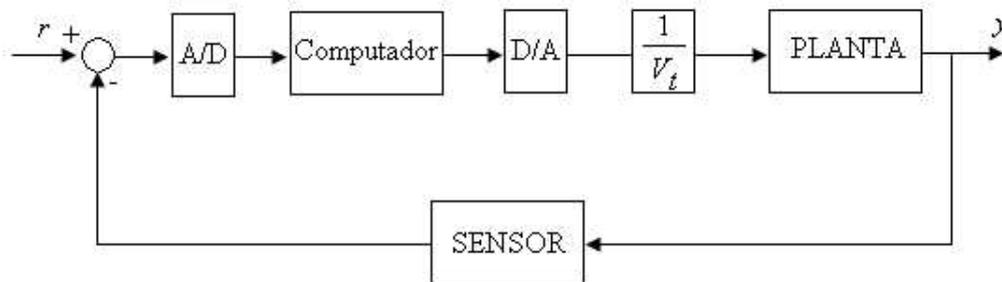
FIGURA 3.16 - Diagrama de blocos com controlador digital.
