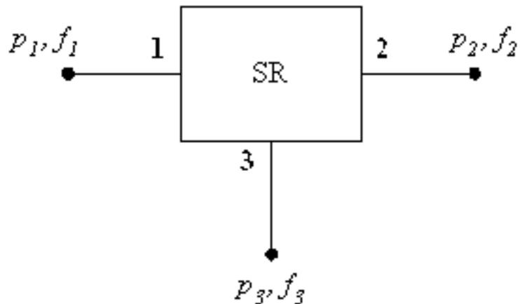
FIGURA 2.3 - Regulador chaveado (SR) como um elemento de três portas.
