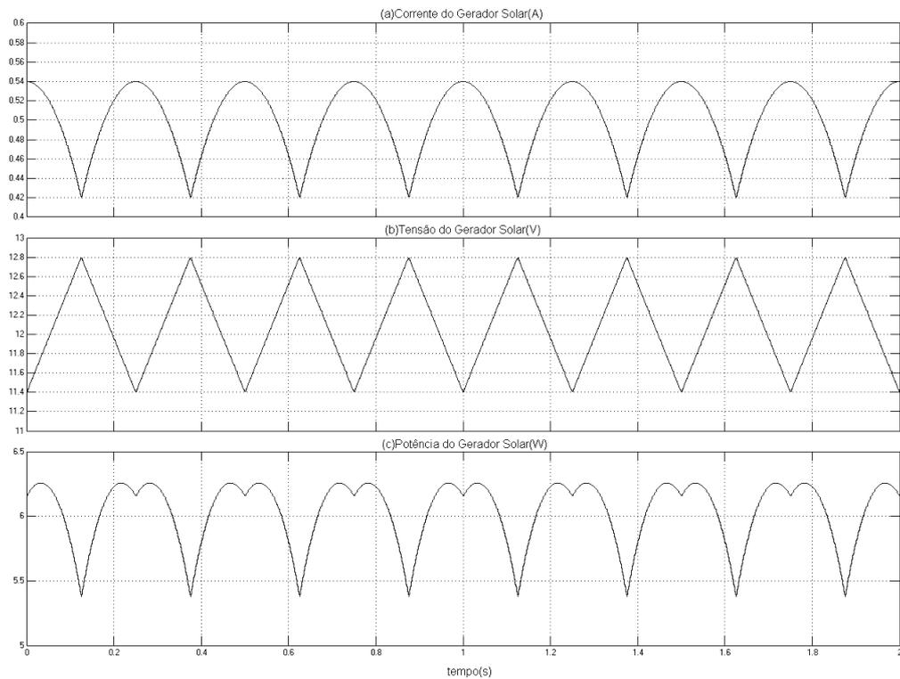
**FIGURA 6.2 - Curvas experimentais(a e b) e calculada(c) do gerador solar.**
