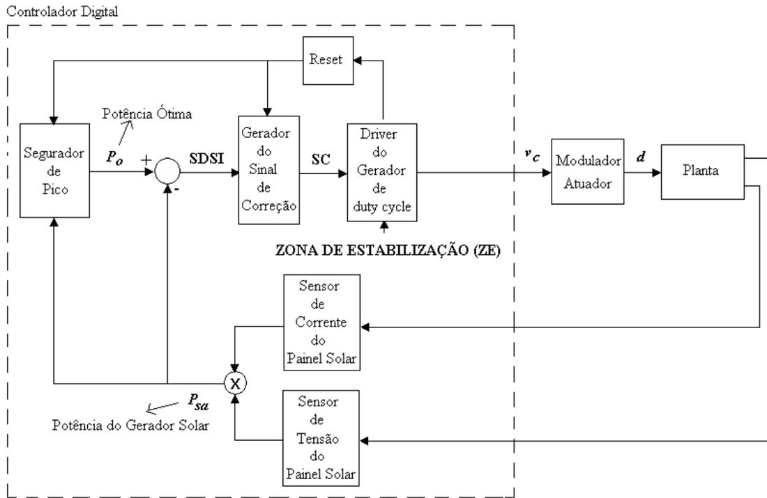
**FIGURA 3.3 - Diagrama de blocos do controlador digital operando no modo “Peak Power Tracking”.**
