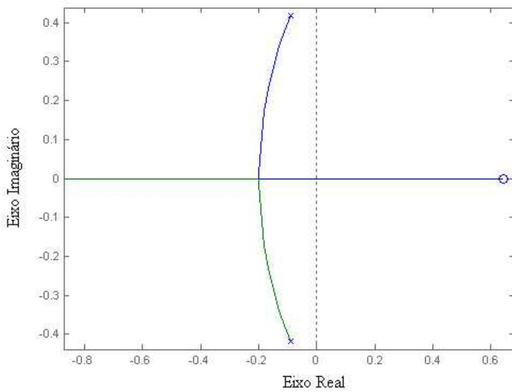
FIGURA 3.19 - Lugar das raízes no plano-z para tempo de amostragem  $T_a=100\mu s$ .
