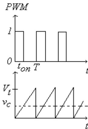
**FIGURA 2.7 - Princípio de funcionamento do modulador.**
