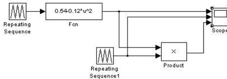
FIGURA 6.1 - Modelo para cálculo da potência do gerador solar.
