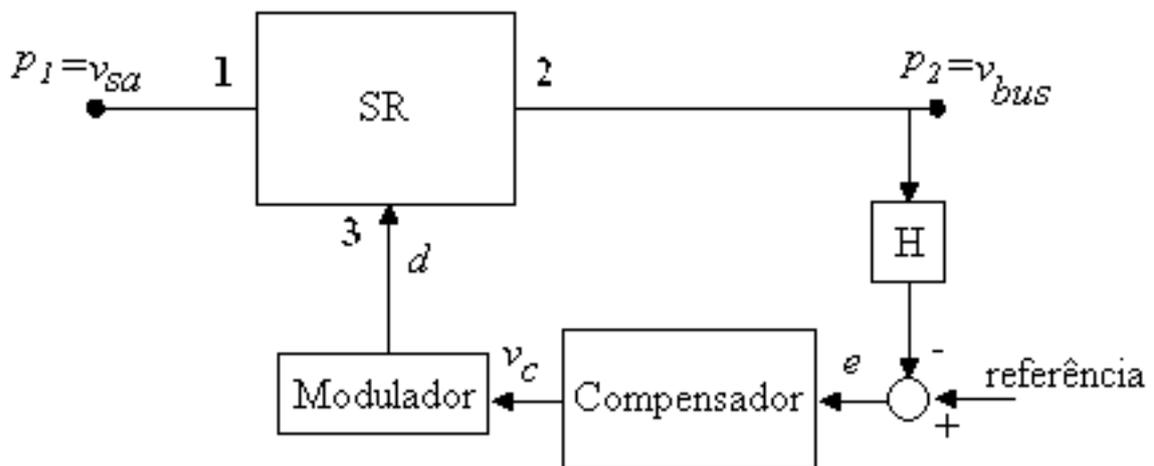
**FIGURA 2.6 - Regulador chaveado com realimentação.**
