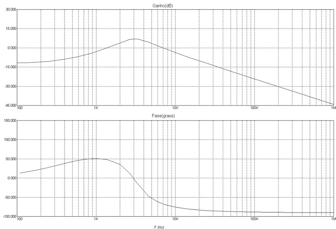
**FIGURA 4.2 - Função de transferência  $G(s)$  da planta.**
