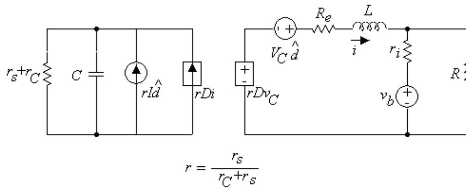
FIGURA 3.15 - Circuito elétrico final após perturbação e linearização.
