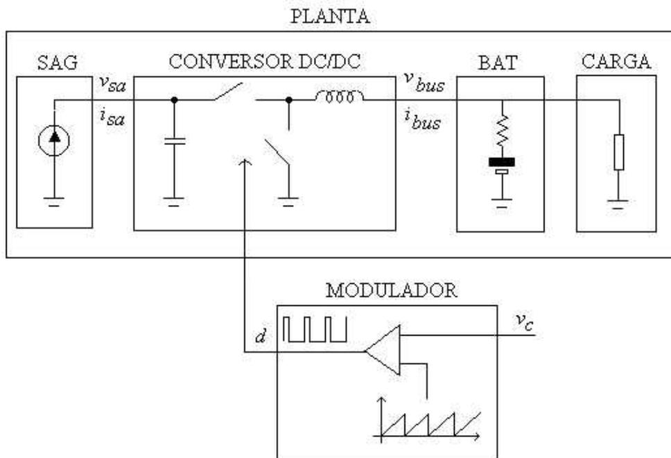
FIGURA 3.17 - Diagrama da planta e modulador.
