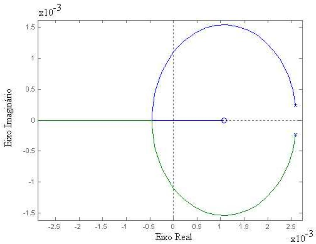
FIGURA 3.21 - Lugar das raízes no plano-z para tempo de amostragem  $T_a=700\mu\text{s}$ .
