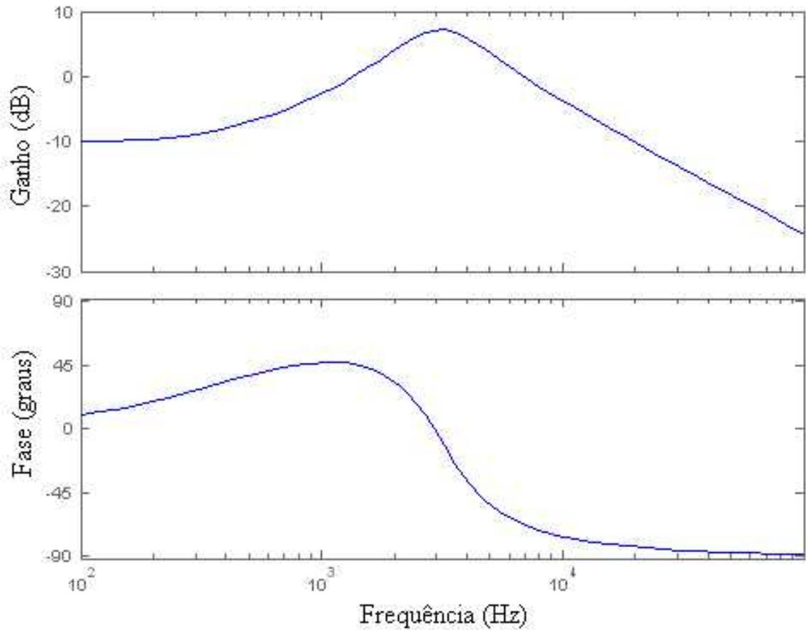
**FIGURA 3.12** - Diagrama de bode da planta.
