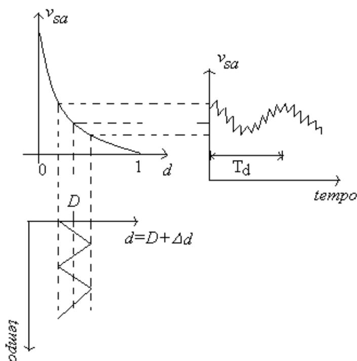
**FIGURA 2.12** - Modulação dos sinais causada por variações de “duty cycle”.
