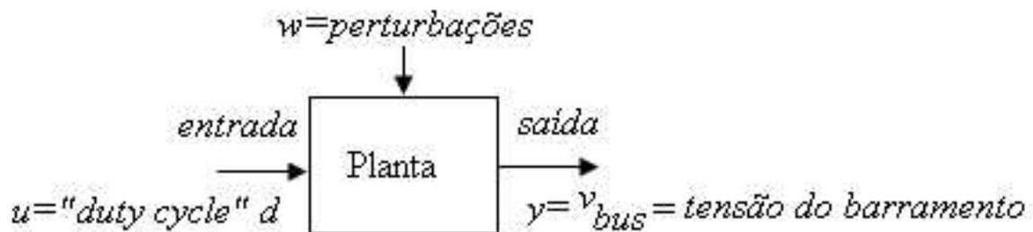
**FIGURA 3.6** - Entrada e saída da planta no segundo modo de operação: “Regulador da Tensão de Final de Carga”.
