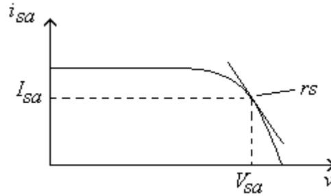
**FIGURA 3.10** - Resistência dinâmica do gerador solar.
