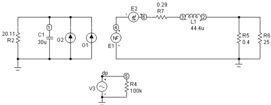
FIGURA 4.1 - Modelo elétrico para pequenos sinais a-c.
