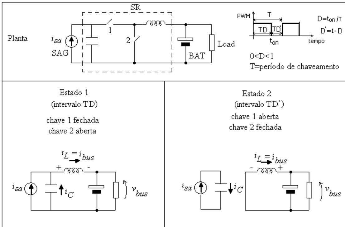
**FIGURA 2.10 - Princípio de funcionamento da planta do sistema de suprimento de energia.**
