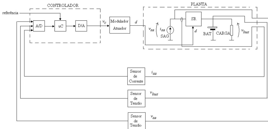
**FIGURA 2.9 - Planta e controlador do sistema de suprimento de energia.**
