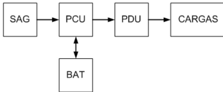
**FIGURA 1.1 - Diagrama de blocos do sistema de suprimento de energia.**
