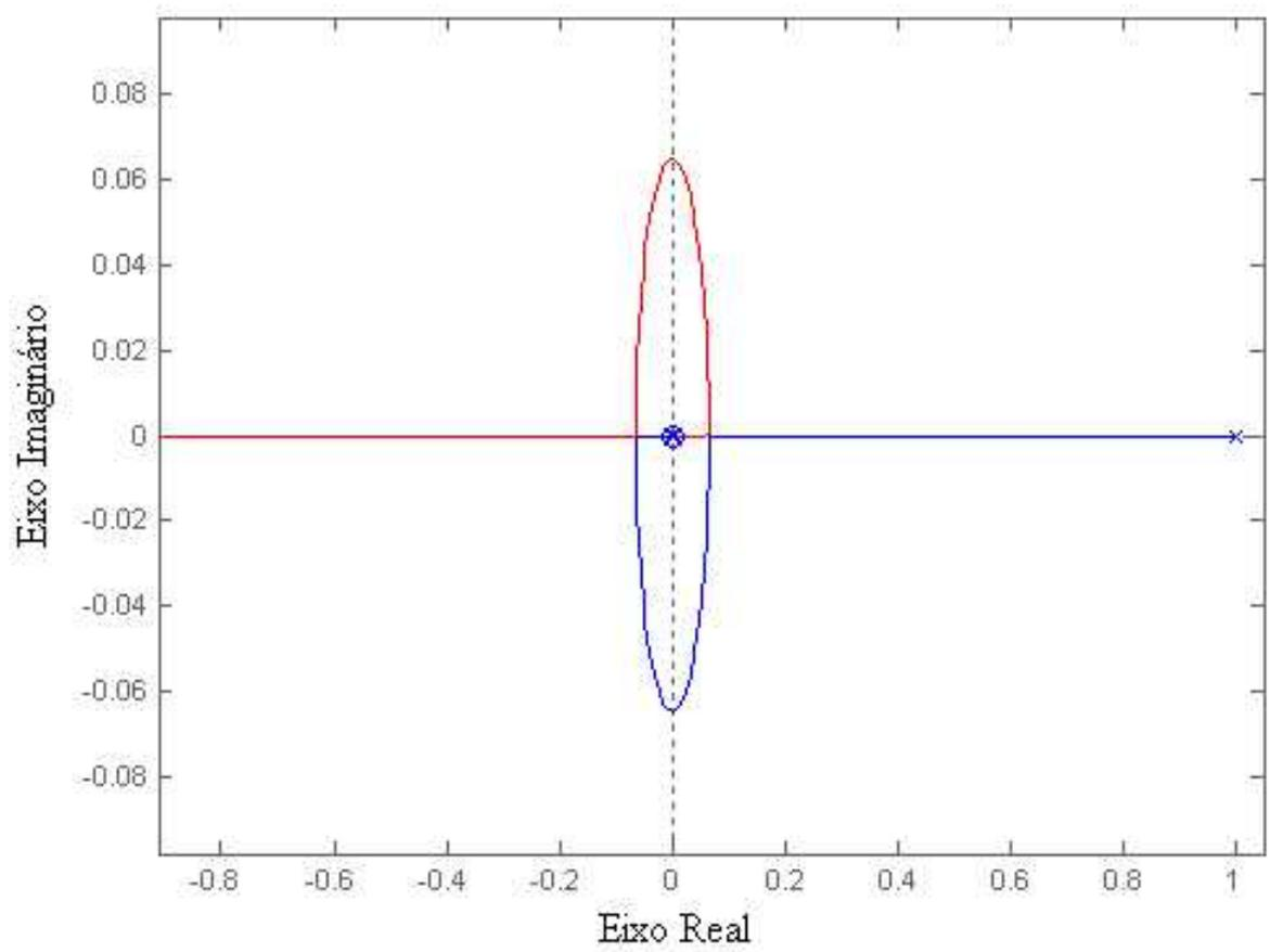
FIGURA 3.22 - Lugar das raízes do sistema compensado com integrador.
