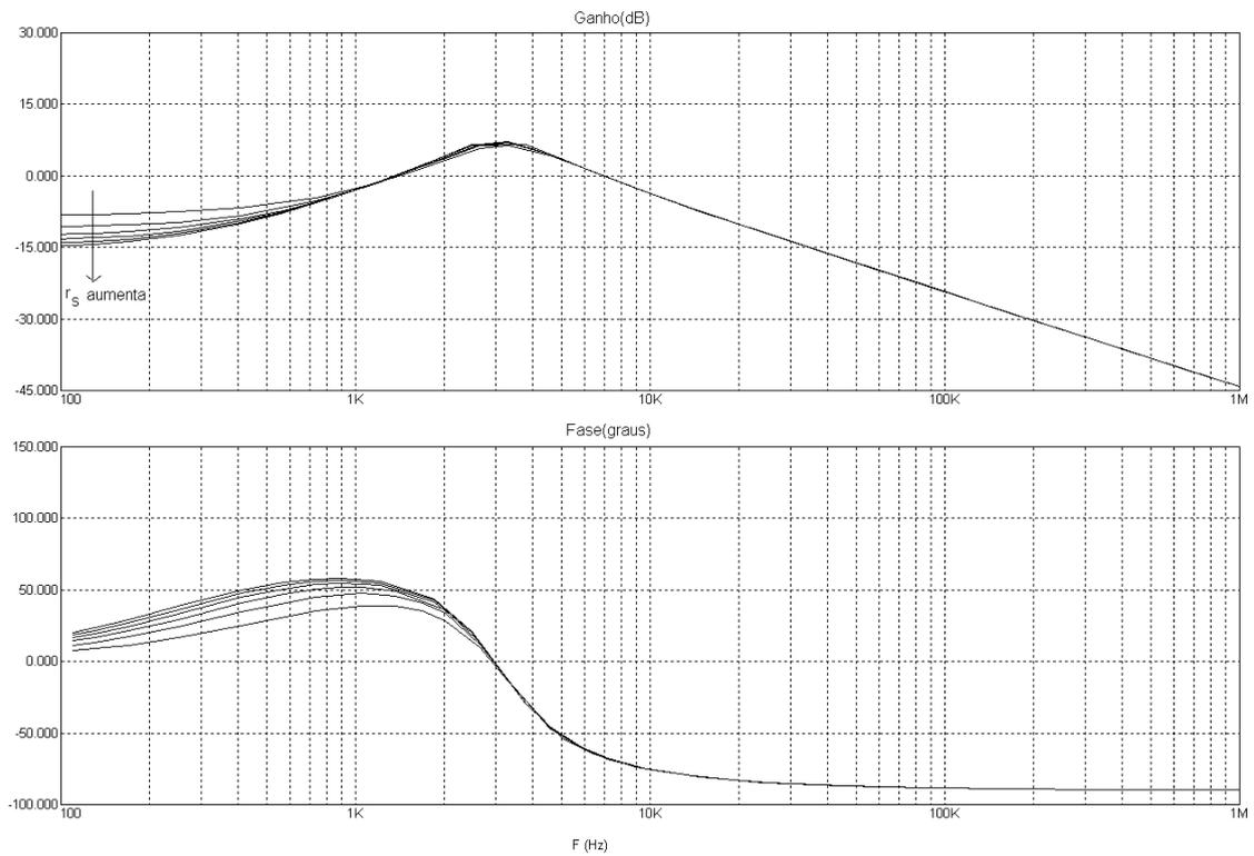
**FIGURA 4.3 - Efeito da variação da resistência dinâmica  $r_s$  do gerador solar.**
