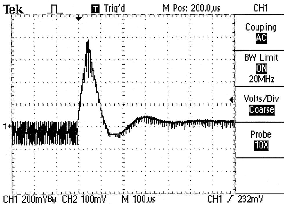
FIGURA 5.2 - Resposta experimental da planta a um degrau.
