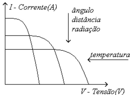
**FIGURA 1.3** - Variações das características do gerador solar com a) temperatura, b) ângulo de incidência, c) distância e d) radiação.
