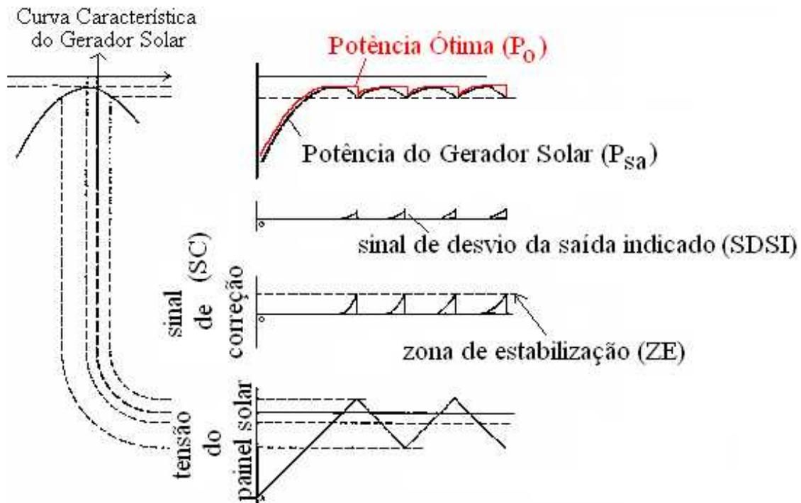
**FIGURA 3.4** - Sinais relevantes no controlador digital durante o modo PPT.
