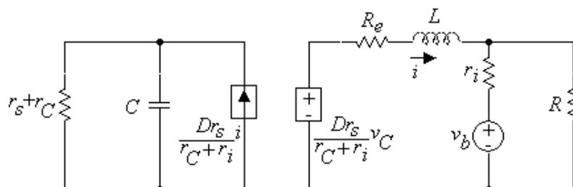
FIGURA 3.14 - Circuito elétrico derivado a partir das equações de espaço-estado.
