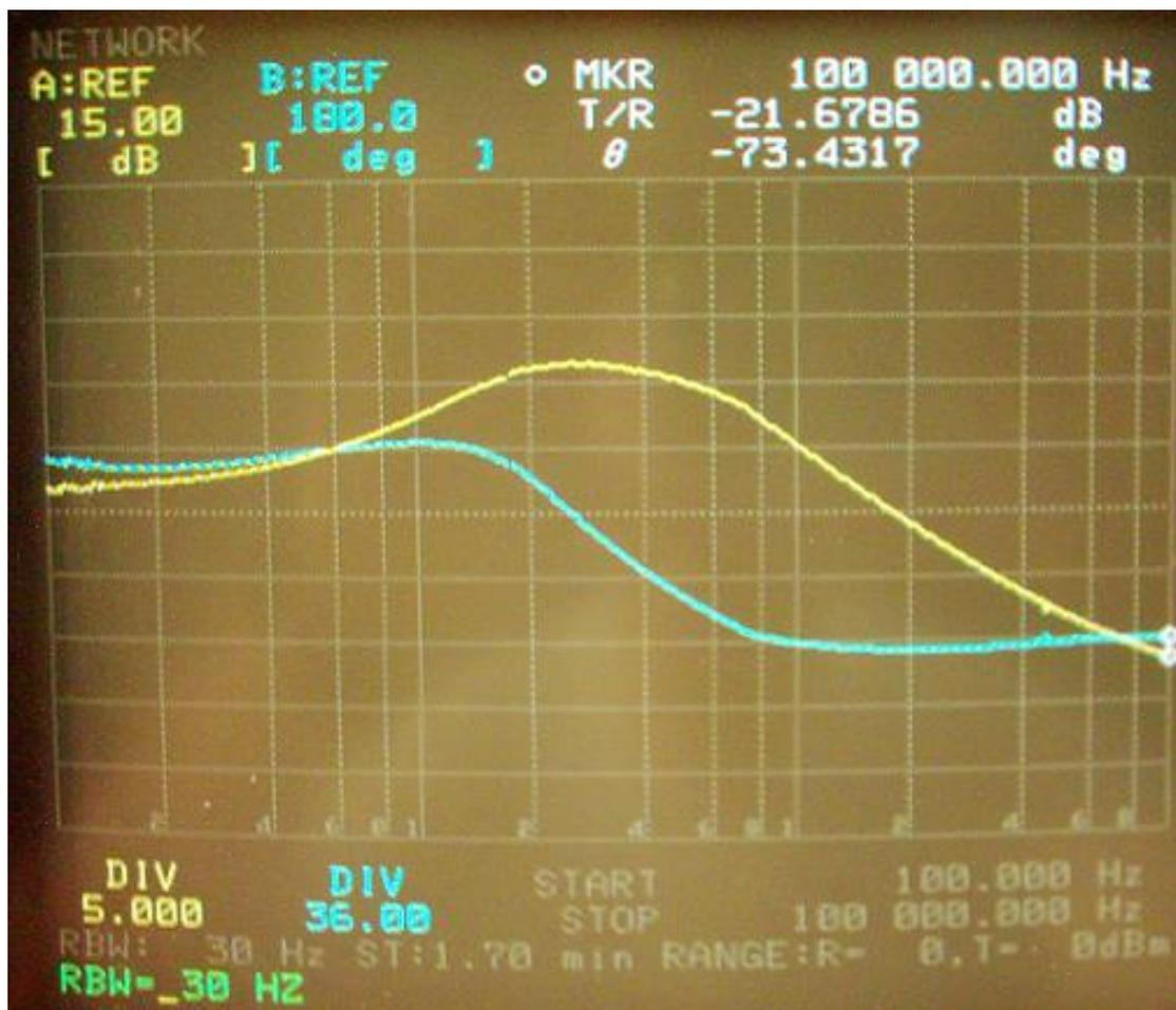
FIGURA 5.3 - Função de transferência experimental da planta.
