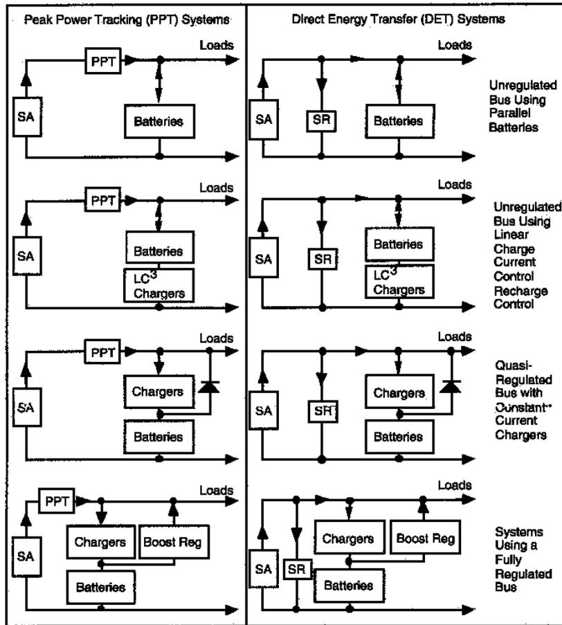
FIGURA 2.1 - Técnicas de controle e regulação em sistemas de suprimento de energia. FONTE: Wertz e Larson (1992).
