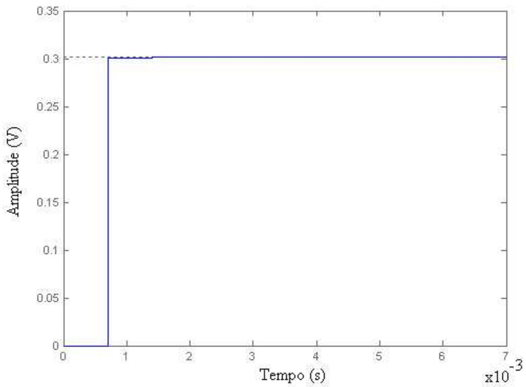
FIGURA 3.20 - Resposta da planta a um degrau para tempo de amostragem  $T_a=700\mu s$ .
