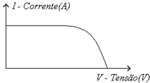
**FIGURA 1.2** - Curva característica de um gerador solar.
