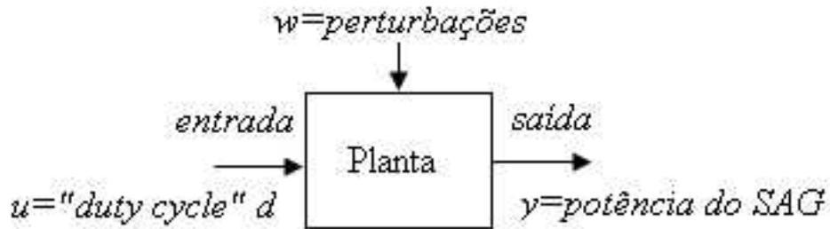
**FIGURA 3.1** - Entrada e saída da planta no modo “Peak Power Tracking”.
