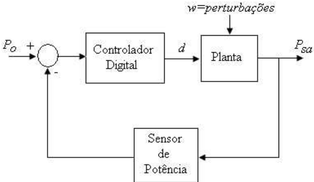
**FIGURA 3.2** - Sistema em malha fechada no primeiro modo de operação: “Peak Power Tracking”.
