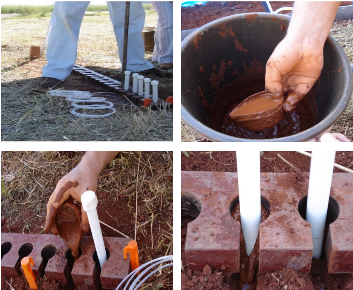
Figura 3 – Instalação dos tensiômetros no solo argiloso utilizando a massa pastosa
