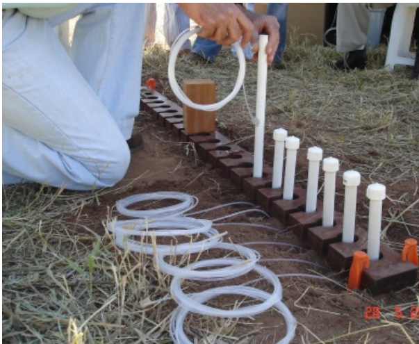
Figura 1 – Disposição das linhas dos tensiômetros na parcela
