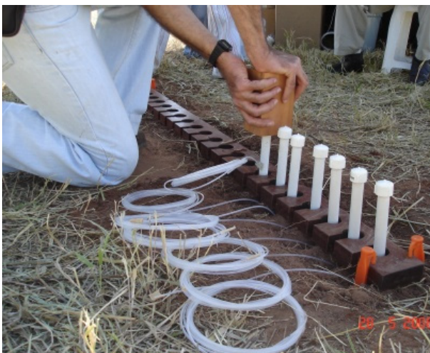
Figura 2 – Instalação dos tensiômetros
