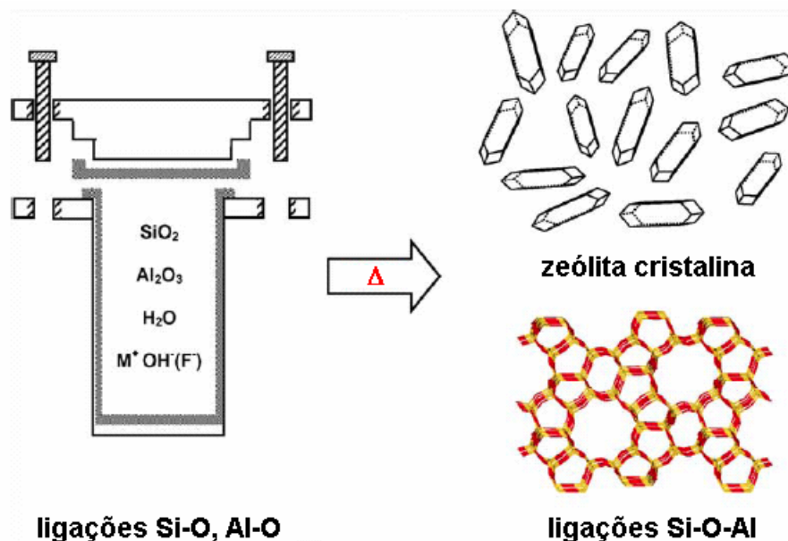
Figura 1: Síntese hidrotérmica de zeólitas: os materiais de origem (ligações Si-O e Al-O) são convertidos por um meio aquoso mineralizante ( \text{OH}^- e/ou \text{F}^- ) no produto cristalino (ligações Si-O-Al) cuja microporosidade é definida pela estrutura. 3,8
