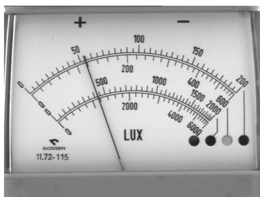
Figura 9.2 - Luxímetro Gossen Panlux, testes 1 e 2, segunda imagem
