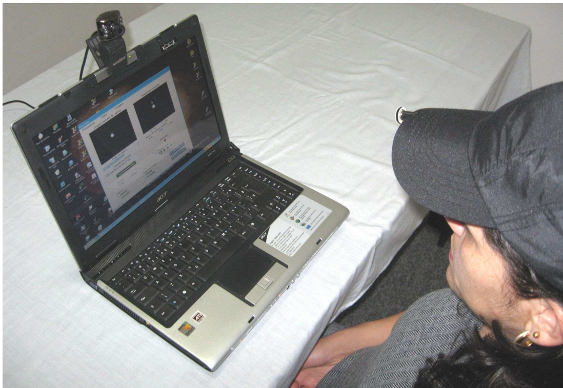
Figura 1- Usuário utilizando o dispositivo apontador constituído de programa de computador, "webcam" e alvo reflexivo preso à aba do boné.
