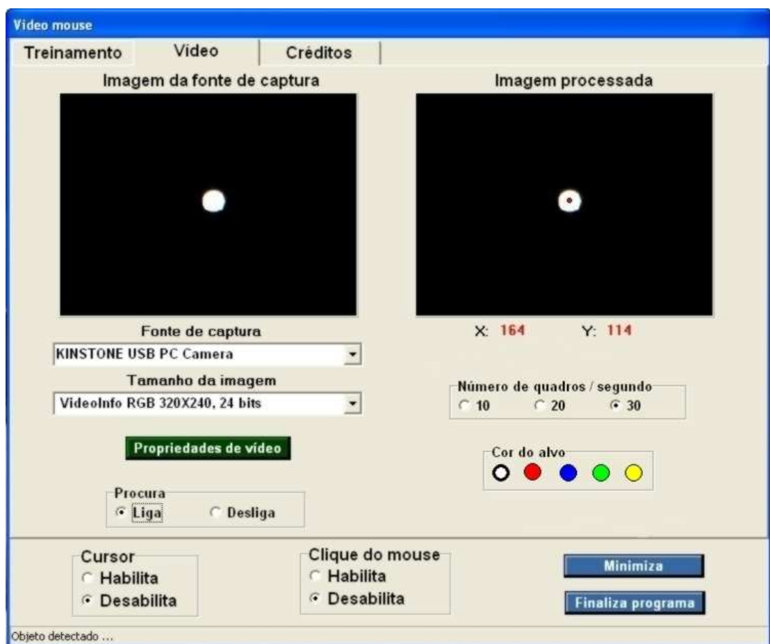
Figura 3- Tela de ajuste dos parâmetros de vídeo necessários para a correta identificação do alvo.
