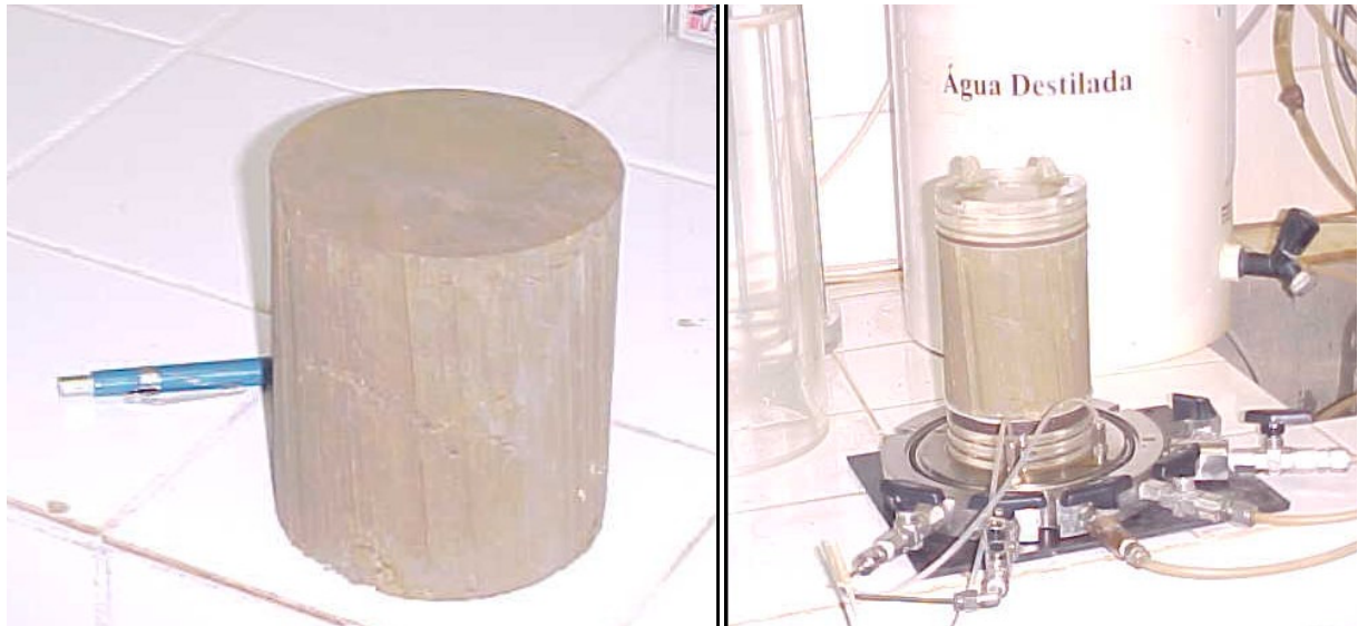
Figura 3.27 – Corpo de prova moldado e câmara de ensaio.
