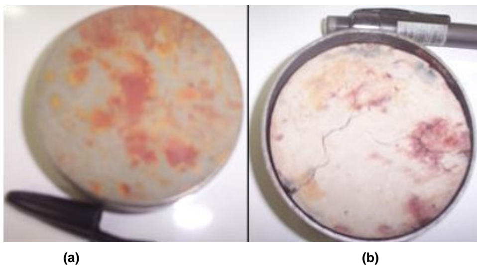
Figura 3.29 – Corpo de prova: (a) antes da colocação na estufa; (b) após a retirada da estufa a 110 C°.
