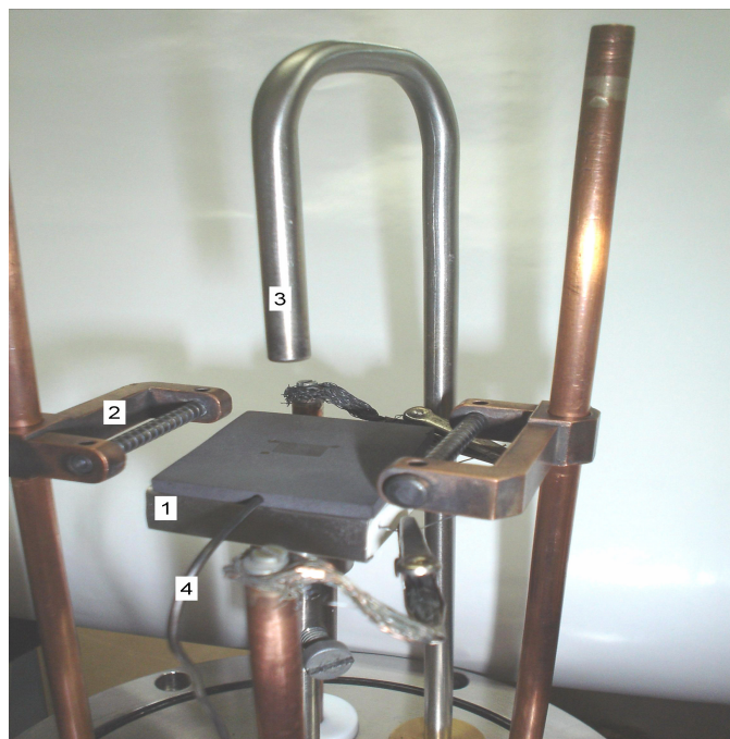
Figura 3.5 – Reator de filamento quente utilizado para as deposições de diamante-CVD nanocristalino.
