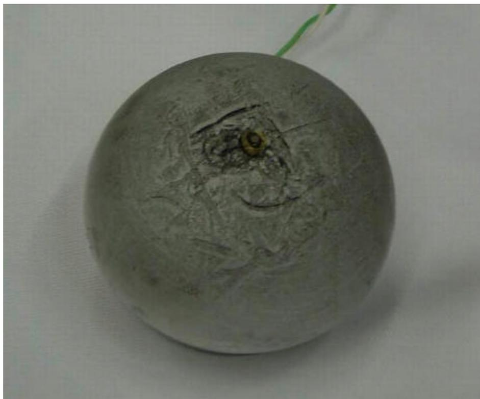
FIGURA 4.1 – Modelo semi-esférico equipado com termopar após ser atingido por destroços dos diafragmas.
