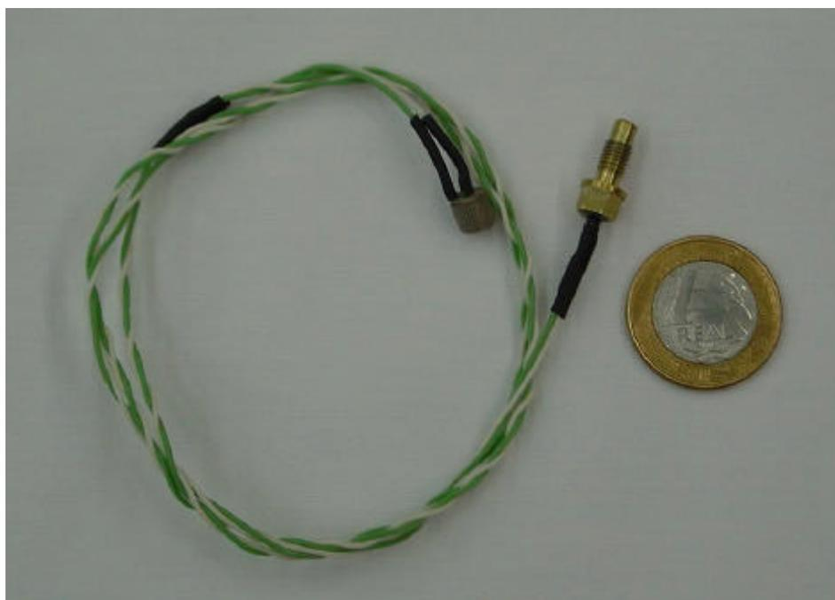
FIGURA 3.2 – Termopar Coaxial desenvolvido no LAH.
